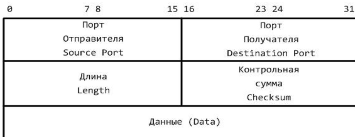
Рис. 7. Формат дейтаграммы UDP (UDP Header Format)
