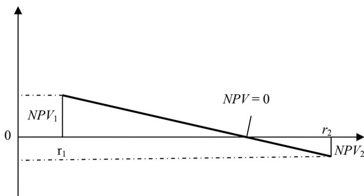
Рис. 6. Графический способ определения *IRR*
