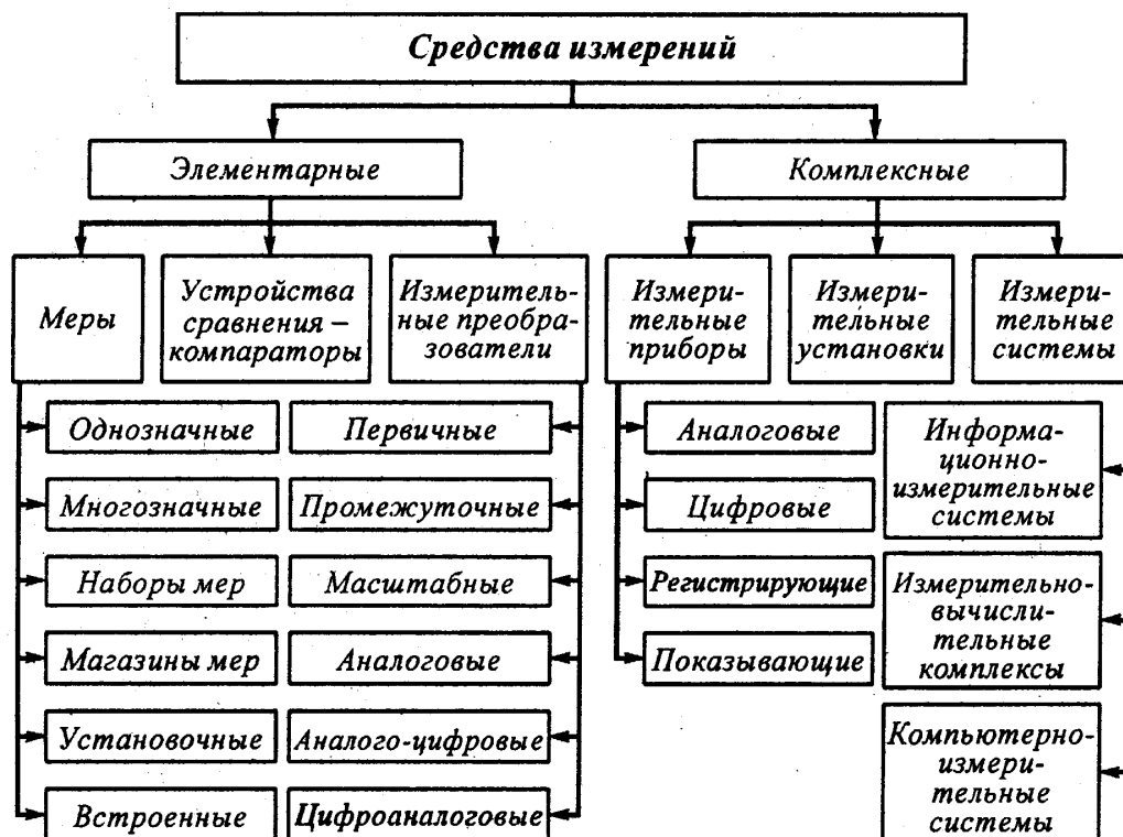
Рис. 1.8. Классификация средств измерений по их роли в процессе измерения и выполняемым функциям
