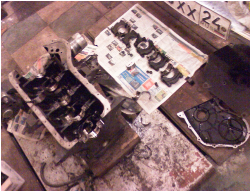
Рисунок 3.1 – Замена вкладышей коленвала
