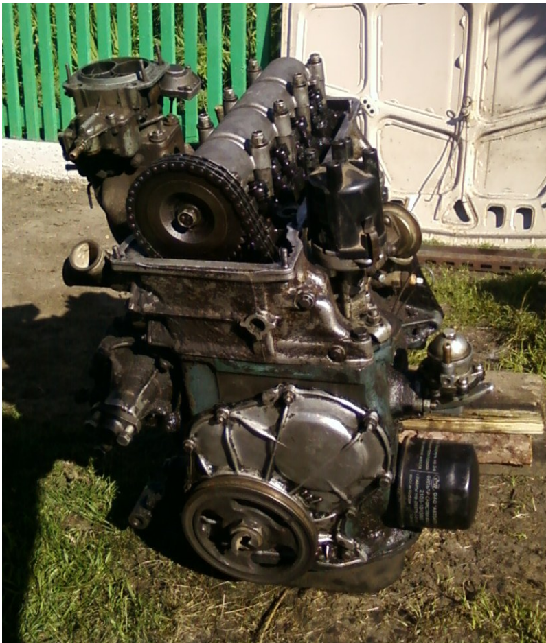
Рисунок 3.3 – Двигатель внутреннего сгорания автомобиля ВАЗ2106
