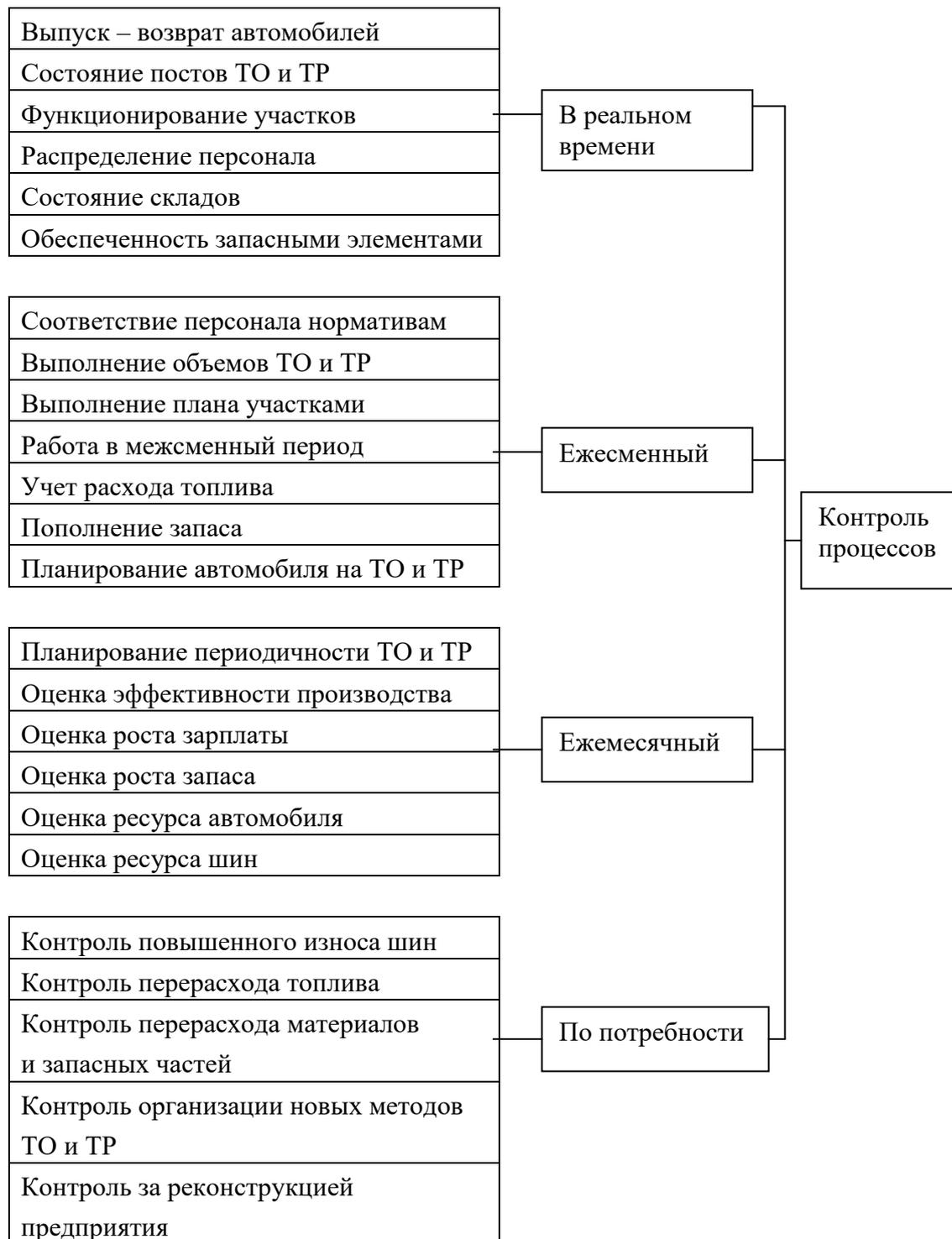
*Рис. 10. Общая схема процессов контроля внутри предприятия автомобильного транспорта*
