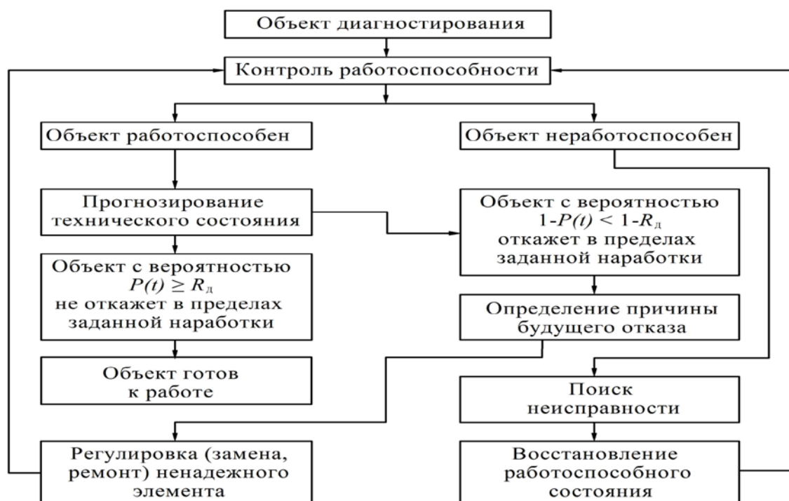
Рис. 1. Схема технического диагностирования автомобилей: R_d – заданная вероятность безотказной работы
