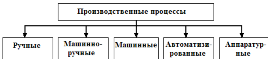
Рис. 5.1. Классификация производственных процессов ремонта АТС в зависимости от степени участия в них человека
