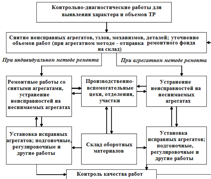
Рис. 3.1. Схема процесса текущего ремонта автомобиля
