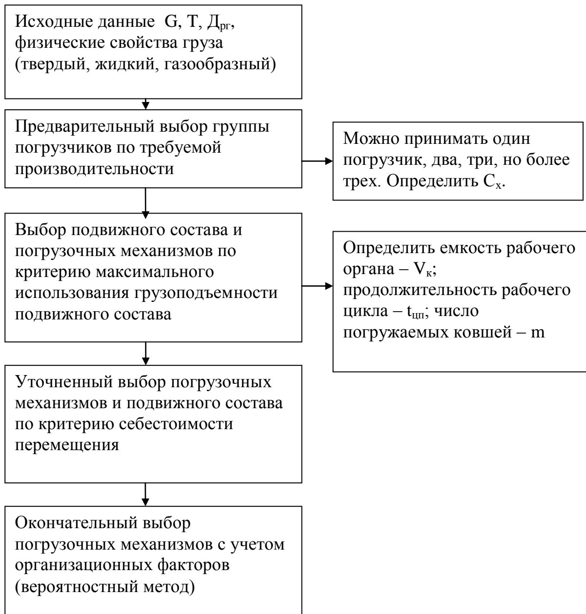
Рис. 6. Алгоритм выбора погрузочных механизмов и подвижного состава
