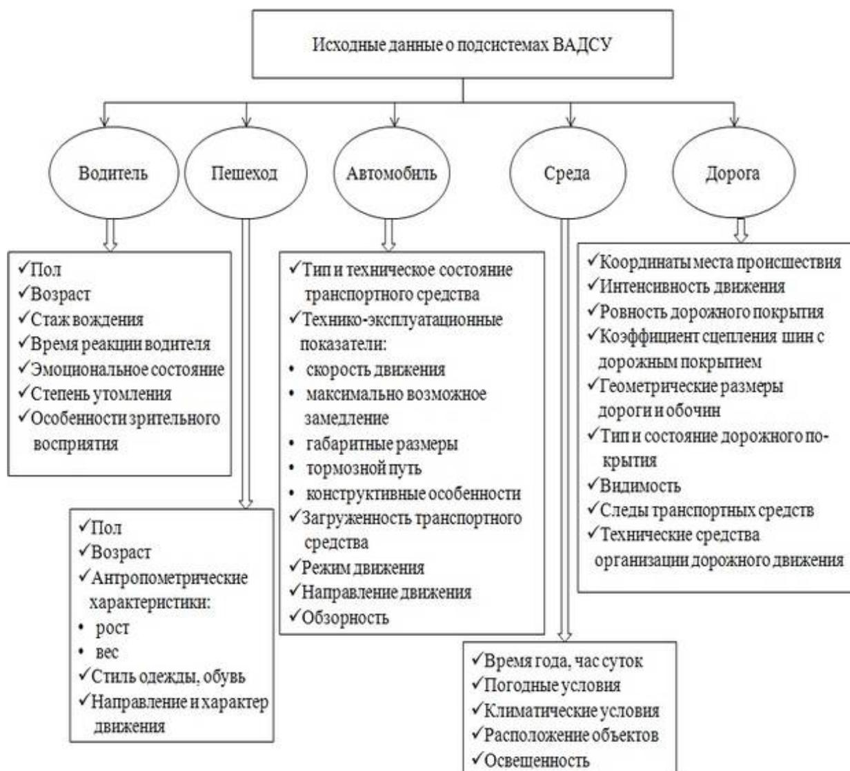
Рисунок 2 – Классификация параметров системы ВАДСУ, являющихся исходными данными при проведении дорожно-транспортной экспертизы происшествий, связанных с наездом автомобиля на пешехода
