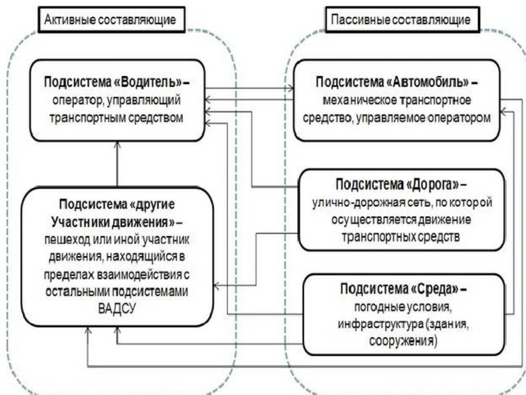
Рисунок 1 – Система Водитель – Автомобиль – Дорога – Среда – другие Участники движения.
