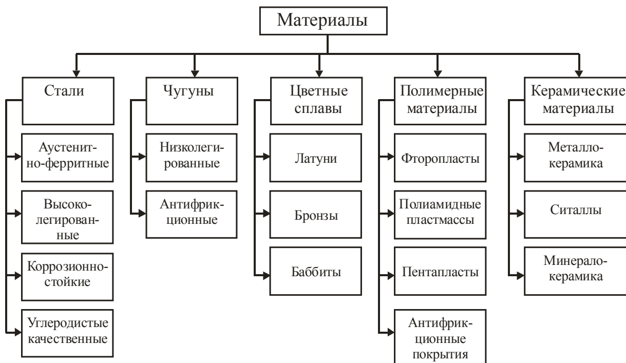
Рис. 5.3. Антифрикционные материалы, используемые в узлах трения
