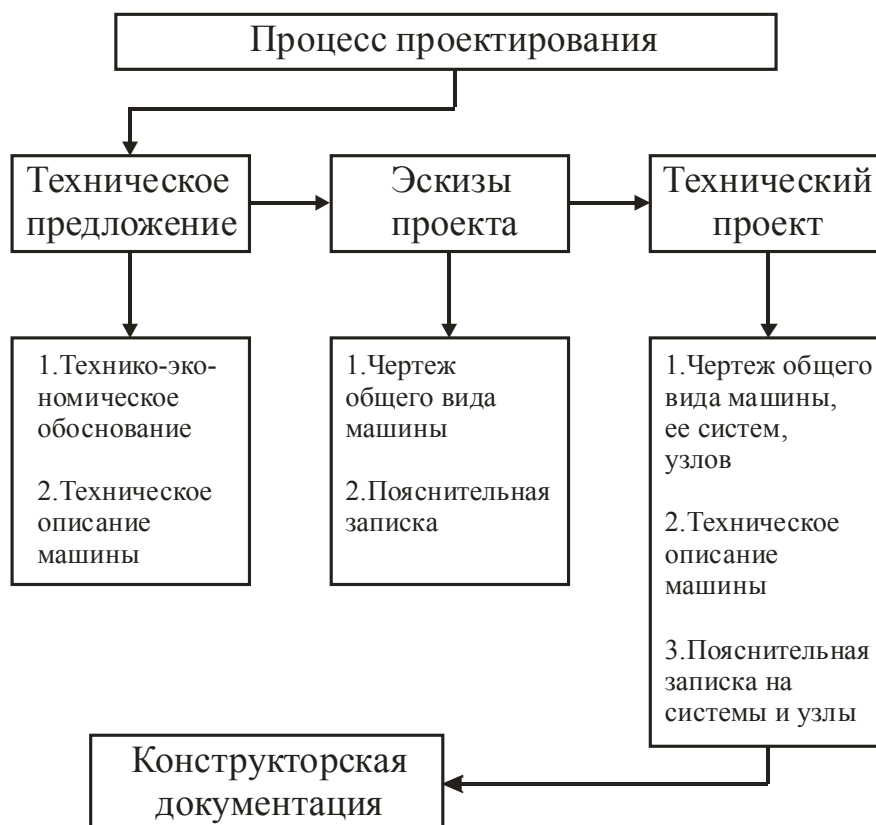
Рис. 5.1. Структура процесса проектирования машины
