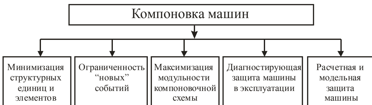
Рис. 5.2. Принципы компоновки машины для обеспечения её высокой надежности
