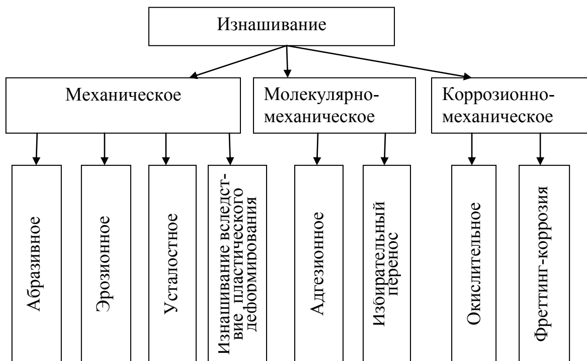
Рис. 4.1 Виды изнашивания деталей
