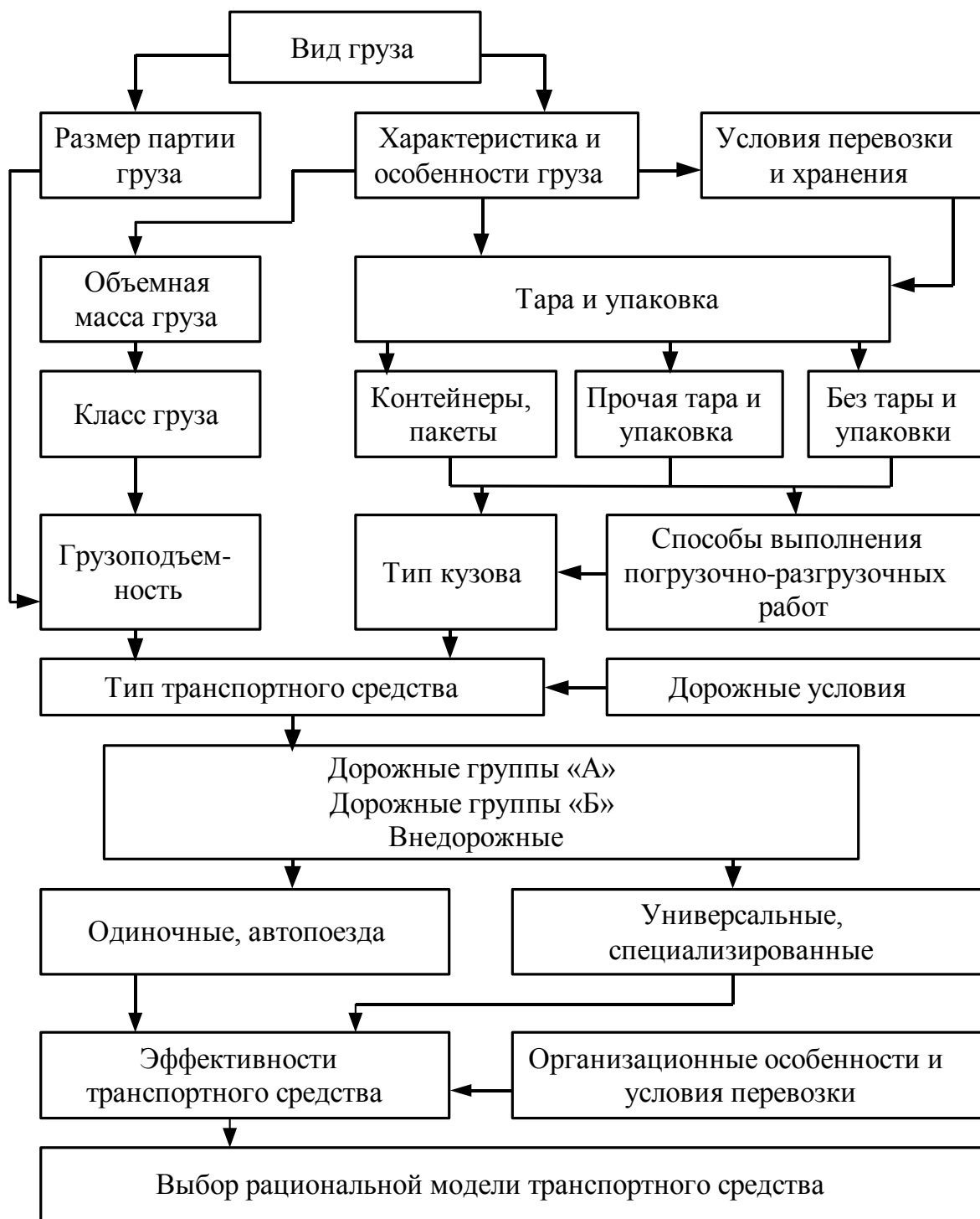
Рис.12. Схема взаимосвязи факторов, влияющих на выбор подвижного состава для перевозки данного вида груза
