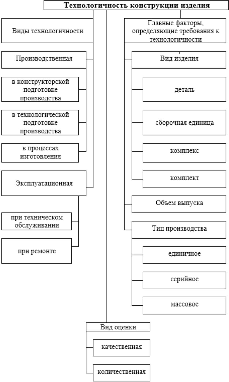
Рис. Технологичность конструкции изделия
