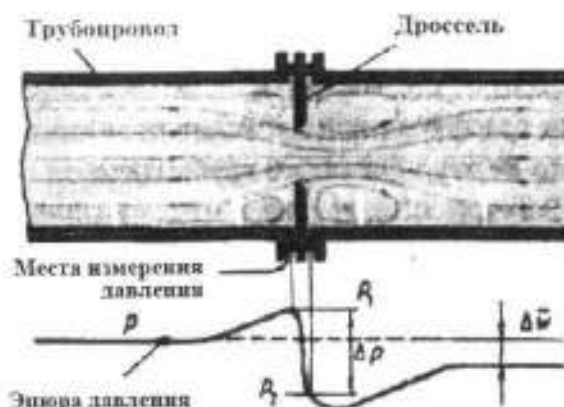
Рис. 9.2. Режим потока и эюра давления в зоне диафрагмы
