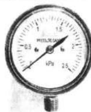
Рис. 9.17. Сифонный манометр [20] с коробчатой пружиной
