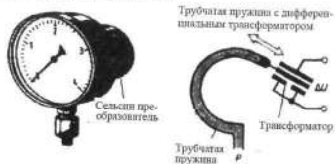
Рис. 9.18. Манометр с трубчатой пружиной с измерительным преобразователем
