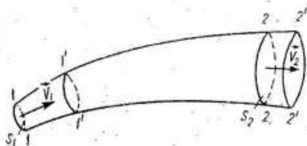
Рис. 2.1. Трубка движения тока жидкости
