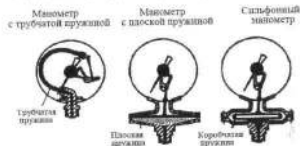
Рис. 9.16. Виды манометров с подпружиненными датчиком
