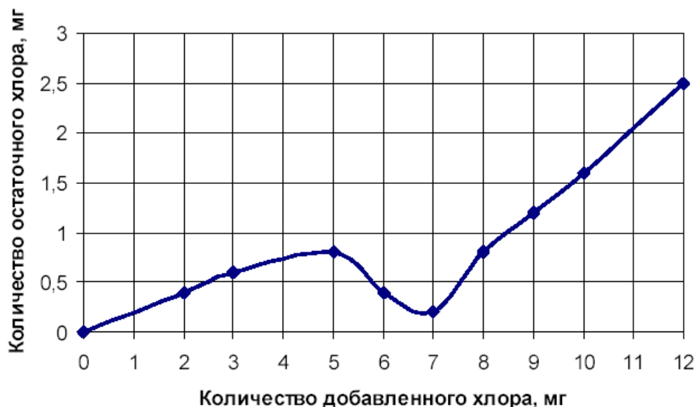
Рис. 6. Кривая йодометрического титрования активного хлора
