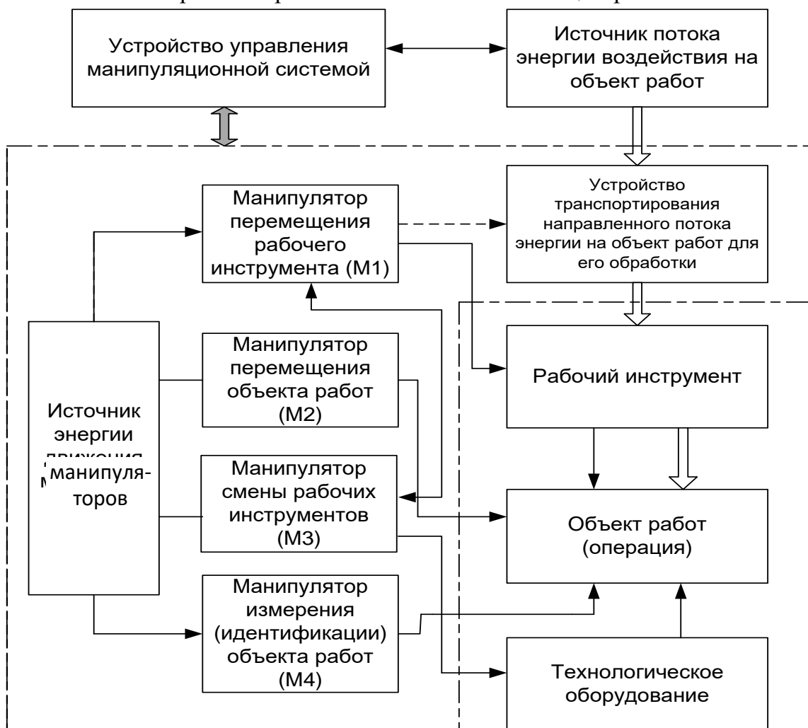
Рис. 1.4. Обобщенная структура многофункциональной манипуляционной системы роботизированного технологического центра
