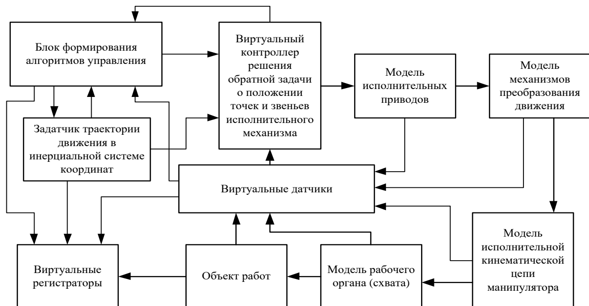
Рис. 4.13. Структурная схема модели исполнительской системы манипуляторов
