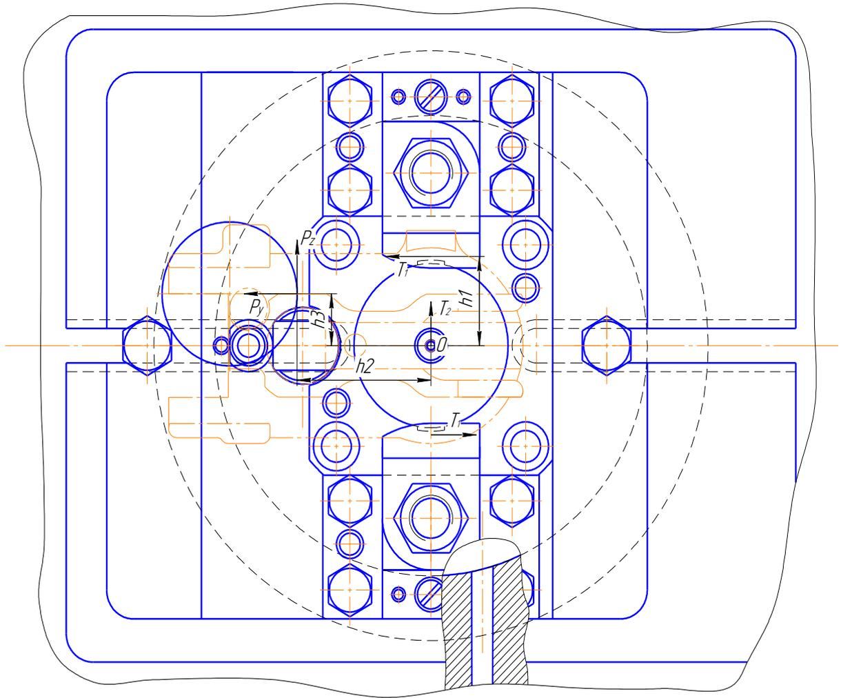
Рис. 5.1. Расчетная схема установки заготовки и силы, действующие на неё.
