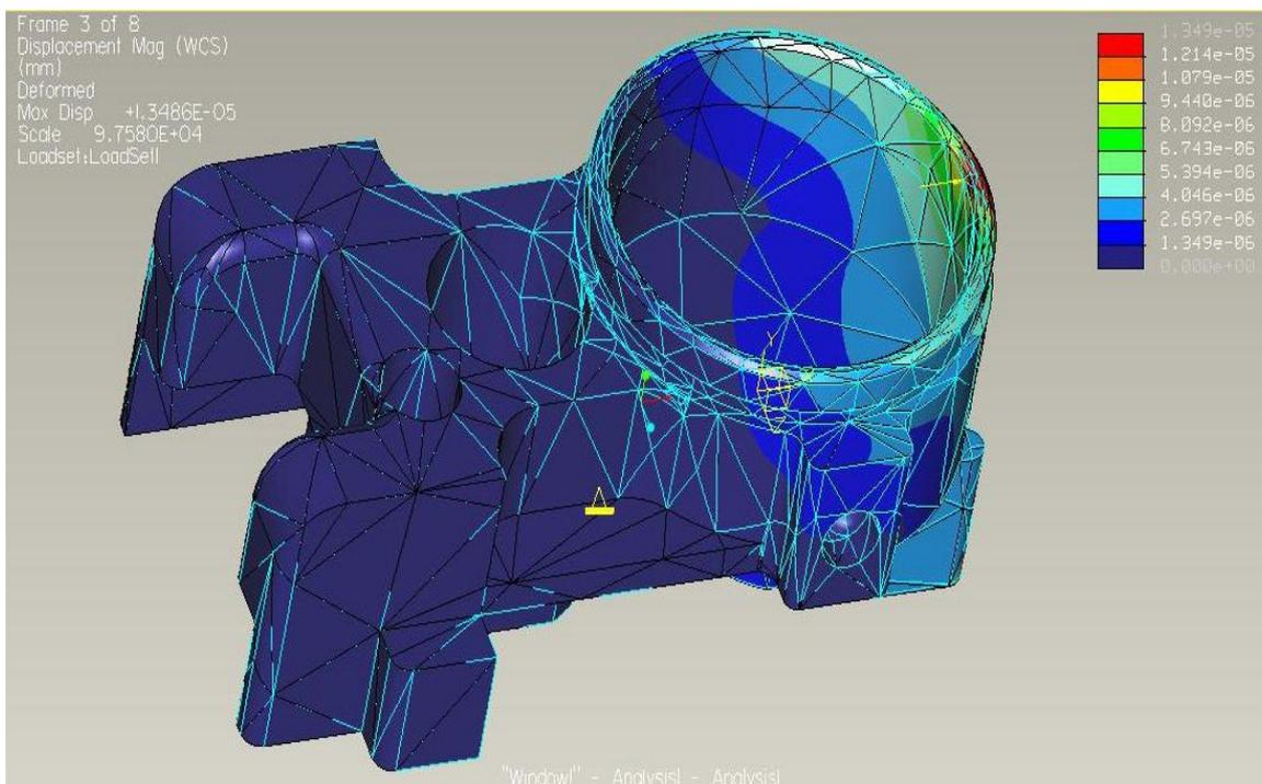
Рис. 4.2 Упругие деформации.
