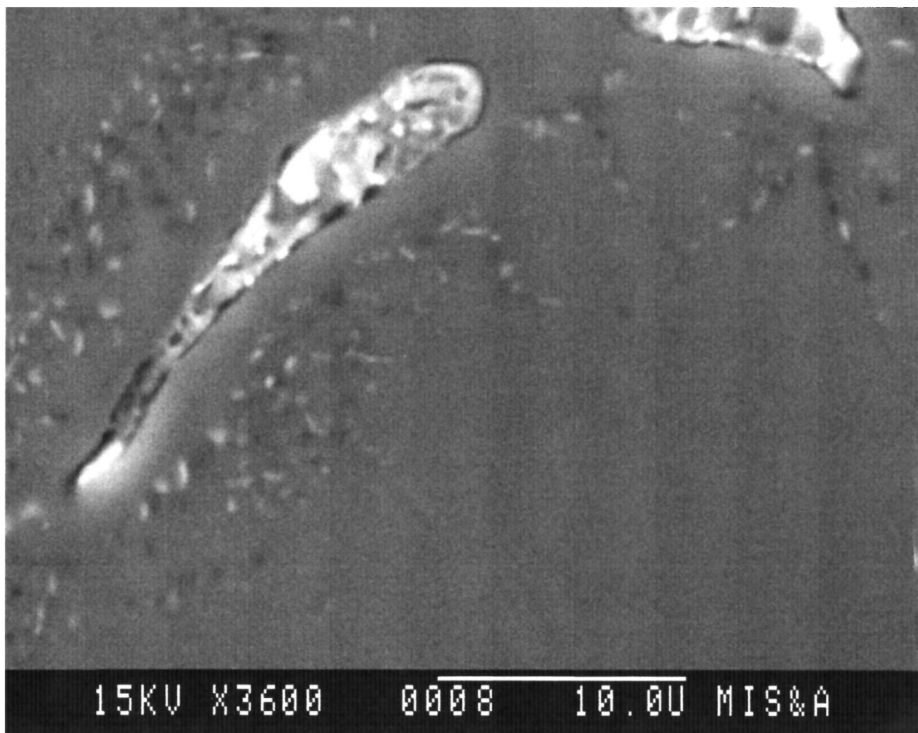
Рис.6. Микроструктура сплава В96Ц, полученного по ИЗОП – технологии, после старения при температуре 120°C в течение 12 час.
