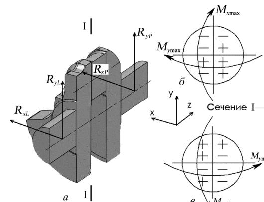
Рис. 65. Схема деформации шатунной шейки:
