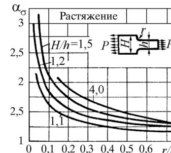
Рис. П7.1. Значение теоретического коэффициента концентрации напряжений от отношения  $r/h$  при известном  $H/h$   $\sigma_h = P/(b \cdot h)$ ;  $\sigma_{max} = \alpha_\sigma \cdot \sigma_h$ , где  $b$  — толщина пластиинки
