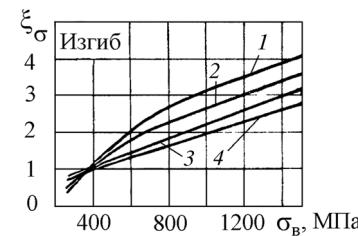
**Рис. П10.2.** Влияние предела прочности на поправочные коэффициенты
