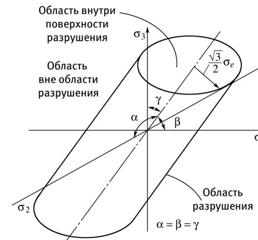
**Рис. 79.** Графическое представление гипотезы удельной энергии формоизменения для случая произвольного напряженного состояния
