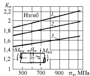
**Рис. П4.2.** Коэффициенты концентрации напряжений при изгибе валов с поперечным отверстием  $\sigma_h = M_{изг} / W_{нетто}$ :
