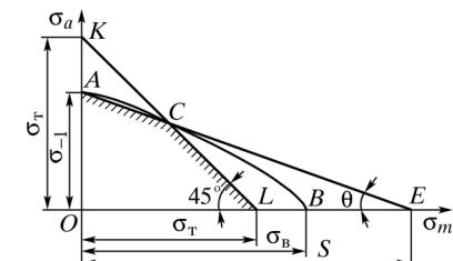
Рис. 31. Схематизированная диаграмма Рабиновича
