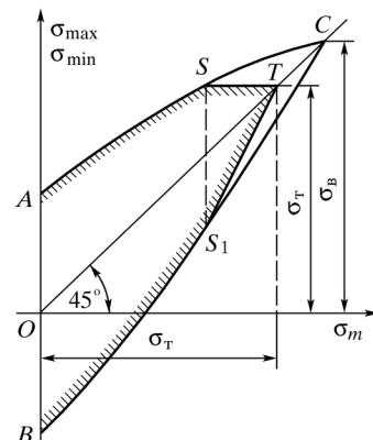
Рис. 26. Диаграмма предельных напряжений Смита для пластичных материалов
