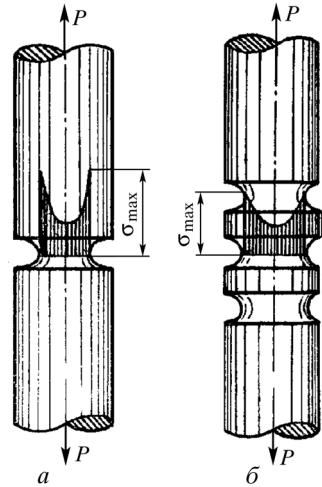
Рис. 88. Снижение концентрации напряжений у дна выточки (а) с помощью дополнительных разгружающих выточек (б)
