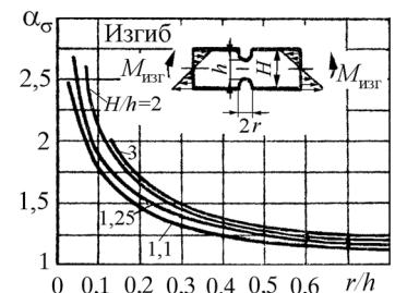
Рис. П7.4. Значение теоретического коэффициента концентрации напряжений от отношения  $r/h$  при известном  $H/h \sigma_h = \frac{M_{\text{изг}}}{(bh^2/6)}$ ;  $\sigma_{\max} = \alpha_{\sigma} \sigma_h$
