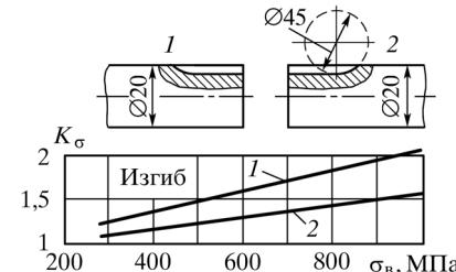
Рис. П12.2. Зависимость коэффициента концентрации напряжений  $K_{\sigma}$  от предела прочности  $\sigma_B$  для валов с одним шпоночным пазом (при двух пазах необходимо вычислить соответствующее значение момента сопротивления  $W_{\text{нетто}}$ )
