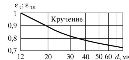
**Рис. 43.** Значения коэффициентов влияния абсолютных размеров при кручении стальных валов
