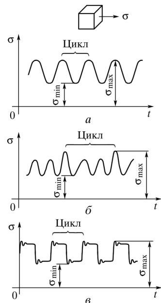
Рис. 5. Различные случаи циклического изменения напряжений во времени
