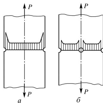
Рис. 87. Снижение концентрации напряжений в полосе с надрезами (а) с помощью дополнительной разгружающей выточки (б)
