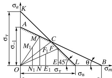
Рис. 54. К определению коэффициента запаса для лабораторного образца по схематизированной диаграмме
