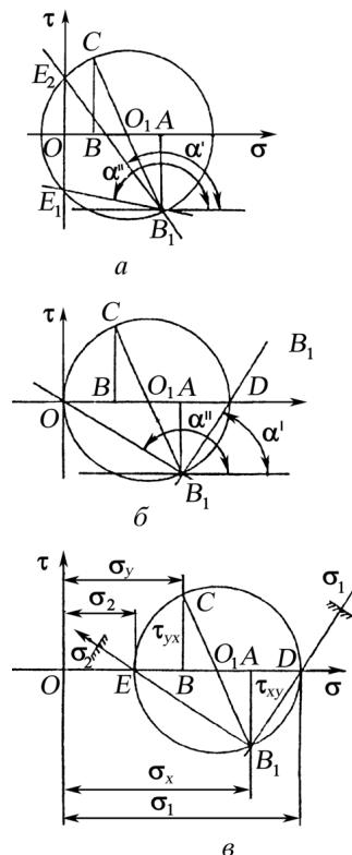
Рис. 76. Графическое изображение различных случаев напряженного состояния
