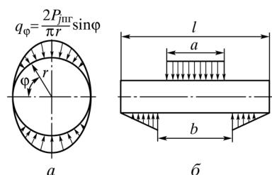
Рис. 71. Расчетные схемы нагружения поршневого пальца от сил инерции  $P_{jpr}$ : *а* — при расчете на овализацию; *б* — при расчете на изгиб и срез
