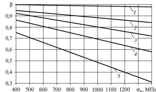
Рис. 47. Коэффициенты, учитывающие состояние поверхности:
