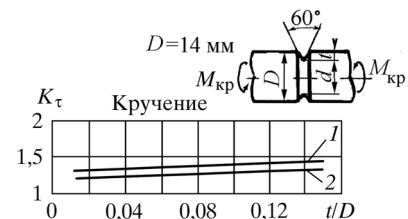
Рис. П6.1. Зависимость  $K_t$  от глубины канавки  $t$  при номинальном напряжении  $\tau_h = M_{kp}/0,2d^3$ :
