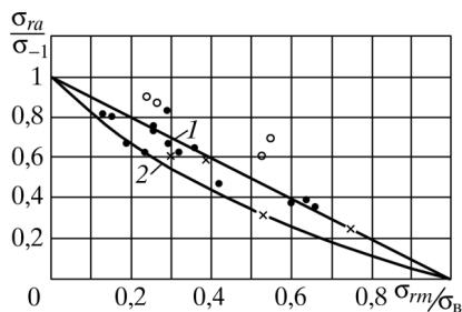
**Рис. 36.** Безразмерная диаграмма  $\sigma_{ra}/\sigma_{-1}$ — $\sigma_m/\sigma_b$  для серого чугуна:
