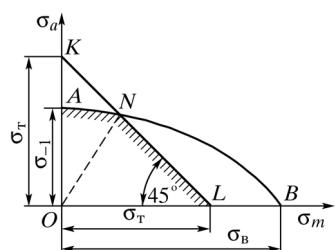
Рис. 24. Диаграмма предельных напряжений для пластичных материалов
