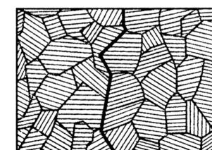
Рис. 16. Кристаллическое строение металла (видна трещина усталости)
