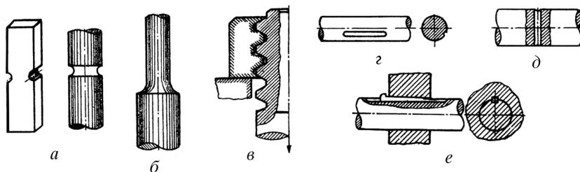
Рис. 38. Концентраторы напряжений:
