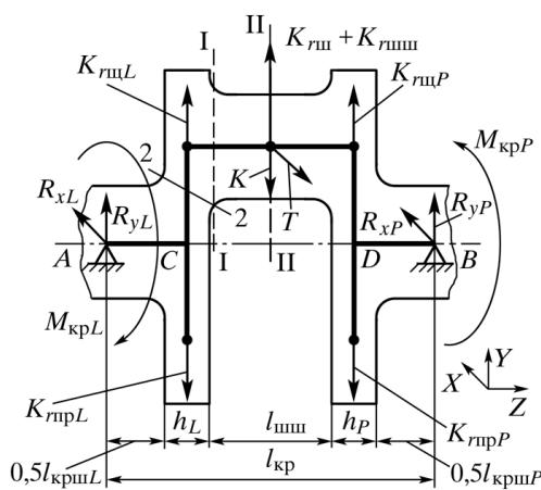
Рис. 62. Расчетная схема кривошипа
