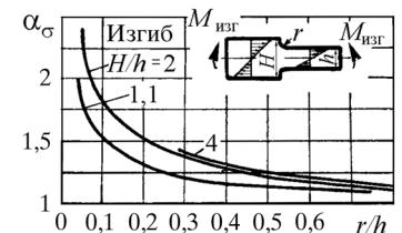
Рис. П7.3. Значение теоретического коэффициента концентрации напряжений от отношения  $r/h$  при известном  $H/h \sigma_h = \frac{M_{\text{изг}}}{(bh^2/6)}$ ;  $\sigma_{\max} = \alpha_{\sigma} \sigma_h$
