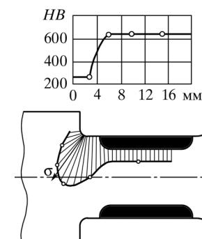
Рис. 89. Распределение напряжений и твердости при перерыве закаленного слоя около галтели
