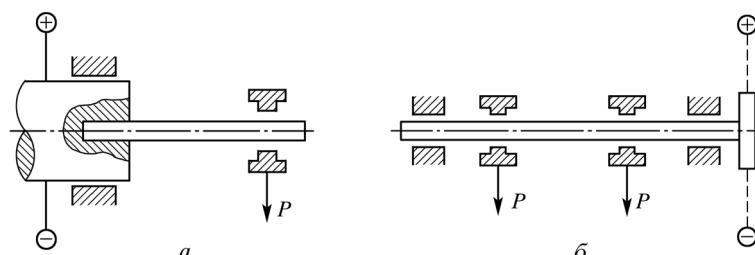
Рис. 7. Схемы нагружения образца при испытании на выносливость:
