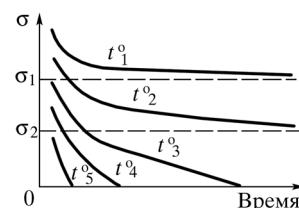
**Рис. 12.** Схема взаимного расположения кривых выносливости (кривых Велера) для металла, испытанного при разных температурах
