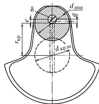
Рис. 63. Расположение облегчающего отверстия в шатунной шейке
