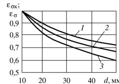
**Рис. 44.** Значение коэффициентов влияния абсолютных размеров сечения  $\varepsilon_\sigma$  и  $\varepsilon_{\sigma_k}$  для чугунных валов при изгибе:
