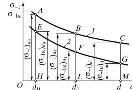
Рис. 46. Графики влияния масштабного коэффициента на величины пределов выносливости при симметричном цикле  $\sigma_{-1}$  (кривая 1) и  $\sigma_{-1k}$  (кривая 2)
