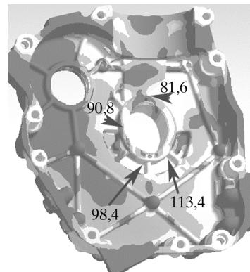
Рис. 81. Значения эквивалентных напряжений
