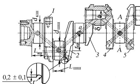
Рис. 64. Чертеж коленчатого вала четырехтактного дизеля: 1, 4, 5 — площадки для установки противовесов; 2, 3 — щеки
