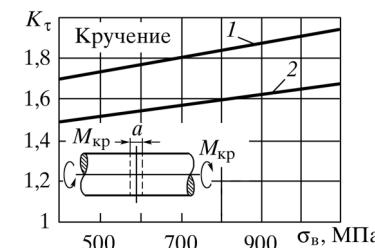
**Рис. П4.3.** Коэффициенты концентрации напряжений при кручении валов с поперечным отверстием:
