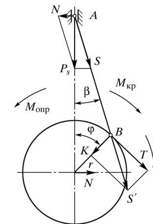
Рис. 59. Суммарные силы и моменты, действующие в кривошипно-шатунном механизме
