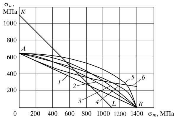
Рис. 28. Диаграммы предельных амплитуд для стали 12ХН3А:
