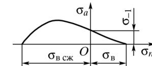
Рис. 27. Диаграмма предельных напряжений Хейга для чугуна
