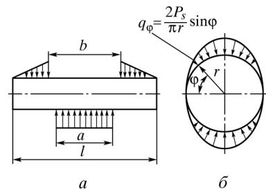
Рис. 70. Расчетные схемы нагружения поршневого пальца от суммарных сил  $P_s$ : *а* — при расчете на изгиб и срез; *б* — при расчете на овализацию
