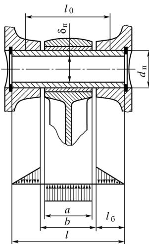
Рис. 69. Расчетная схема поршневого пальца
