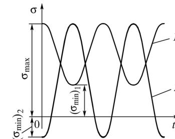
Рис. 6. Графики переменных напряжений с различными амплитудами
