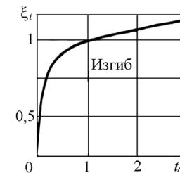
**Рис. П5.3.** Поправочный коэффициент  $\xi_t$ , учитывающий влияние отношения  $t/r$ .  $\xi_t = (K - 1)/(K_0 - 1)$ , где  $K$  — значение  $K_\sigma$  при данном  $t/r$ ;  $K_0$  — значение  $K_\sigma$  при  $t/r = 1$
