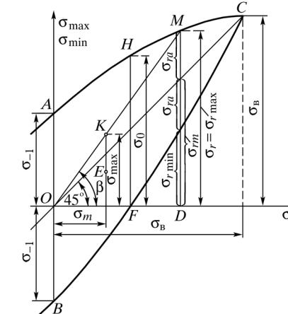
Рис. 25. Диаграмма предельных напряжений в координатах  $\sigma_{\max}$ ,  $\sigma_{\min} - \sigma_m$
