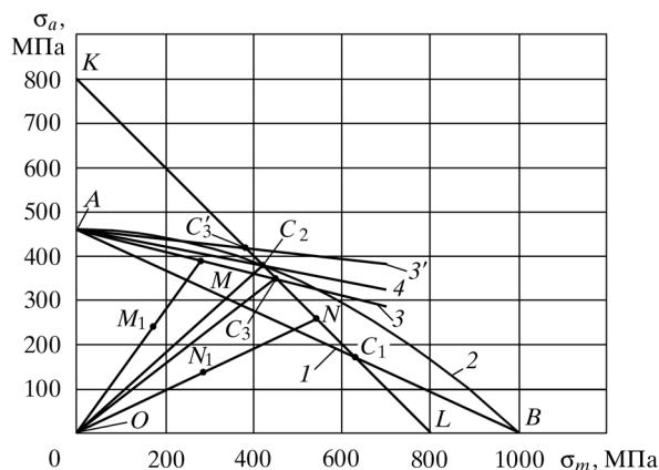
Рис. 33. Диаграмма предельных амплитуд для стали 40ХН:
