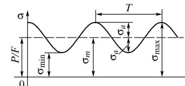
Рис. 3. Несимметричный цикл изменения напряжений
