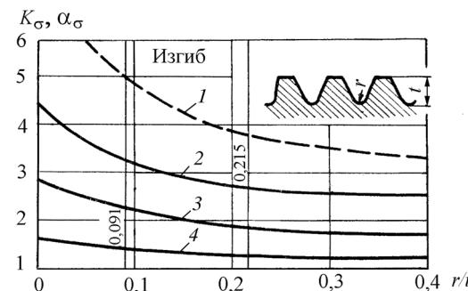
**Рис. П10.1.** 1 —  $\alpha_\sigma$ ; 2 — легированная сталь ( $\sigma_B > 1500$  МПа),  $d = 15$  мм; 3 — легированная сталь ( $\sigma_B = 800$  МПа),  $d = 15$  мм; 4 — углеродистая сталь ( $\sigma_B = 400$  МПа),  $d = 15$  мм; отношение  $r/t = 0,091$  соответствует метрической резьбе, а  $r/t = 0,215$  — резьбе Витворта
