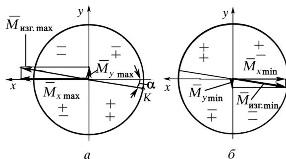
Рис. 66. Схема нагружения шатунной шейки изгибающими моментами:
