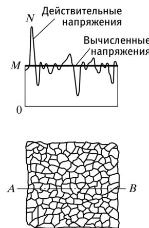
Рис. 17. Вычисленные и действительные напряжения в металле по линии A—B
