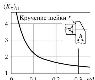
Рис. П13.2. Значение  $(K_\tau)_D = K_\tau / \epsilon_\tau$  при кручении щеки коленчатого вала при  $d = 40 \dots 70$  мм
