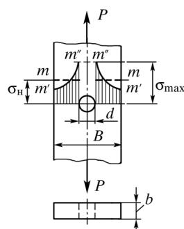
Рис. 39. Эпюра распределения нормальных напряжений в растягивающей полосе, ослабленной круглым отверстием
