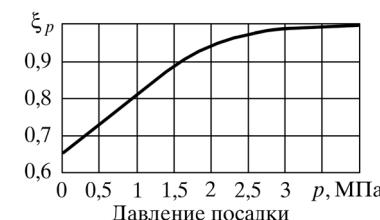
Рис. П8.2. Зависимость поправочного коэффициента  $\xi_p$  от давления посадки  $(K_{\sigma})_p = \xi_p (K_{\sigma})_{p \geq 30 \text{ МПа}}$ , где  $\xi_p = (K_{\sigma})_p / (K_{\sigma})_{p=30}$
