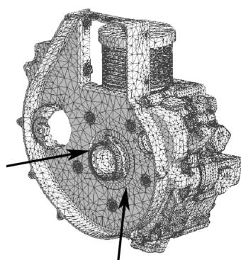
Рис. 80. Расчетная КЭ модель сборки блок-картера: узлов — 457 782, элементов — 247 028
