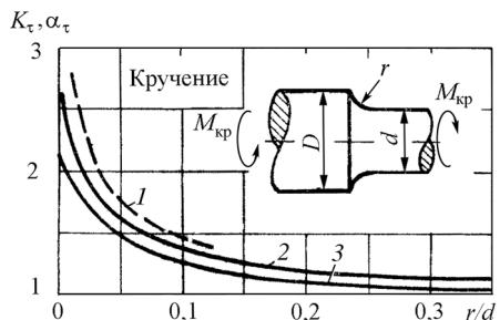
**Рис. П3.1.** Коэффициенты концентрации напряжений:
