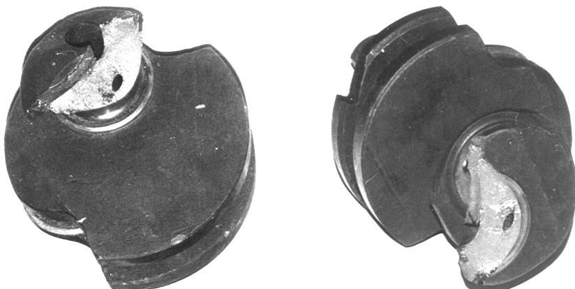
Рис. 20. Разрушение коленчатого вала дизеля 2Ч 7,6/8,0 (конструкции НИКТИД) по щеке от действия напряжений изгиба
