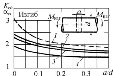
**Рис. П4.1.** Коэффициенты концентрации напряжений  $K_\sigma$  и  $(K_\sigma)_D$  при изгибе валов с поперечным отверстием  $\sigma_h = M_{изг} / W_{нетто}$ :
