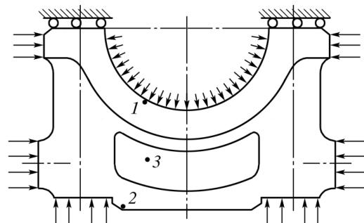
Рис. 77. Расчетная схема крышки коренных подшипников дизеля А-90ТК с указанием точек, напряженное состояние которых исследуется
