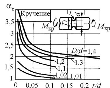
Рис. П6.2. Зависимость  $\alpha_\tau$  от радиуса канавки  $r$  при номинальном напряжении  $\tau_h = M_{kp}/0,2d^3; \tau_{max} = \alpha_\tau \tau_h$
