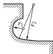
Рис. 84. Переходная галтель с поднутрением
