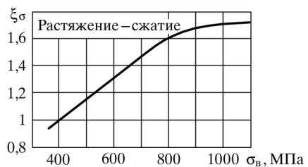
**Рис. П9.2.** Определение действительного коэффициента концентрации напряжений с учетом предела прочности ( $K_\sigma$ )<sub>σ<sub>B</sub>=400</sub> =  $\xi_\sigma \cdot (K_\sigma)$ <sub>σ<sub>B</sub>=400</sub>
