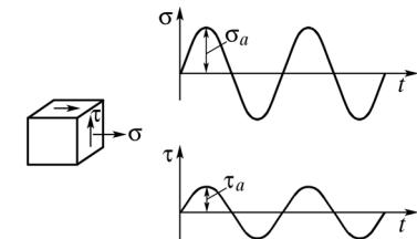
Рис. 57. Синфазное изменение нормальных и касательных напряжений по симметричным циклам
