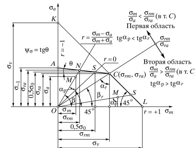
Рис. 56. Применимость схематизированной диаграммы усталостной прочности
