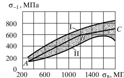
Рис. 21. Опытные данные по установлению зависимости между  $\sigma_{-1}^{\text{u}}$  и  $\sigma_b$  для сталей
