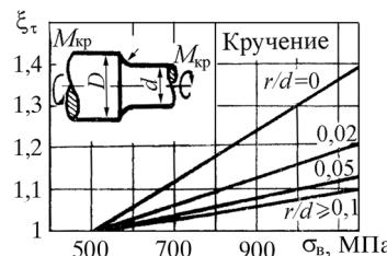
**Рис. П3.2.** Поправка  $\xi_\tau = \frac{(K_\tau)_{\sigma_B}}{(K_\tau)_{\sigma_B=500}}$ , учитывающая влияние предела прочности  $\sigma_B$  при  $D/d = 2$
