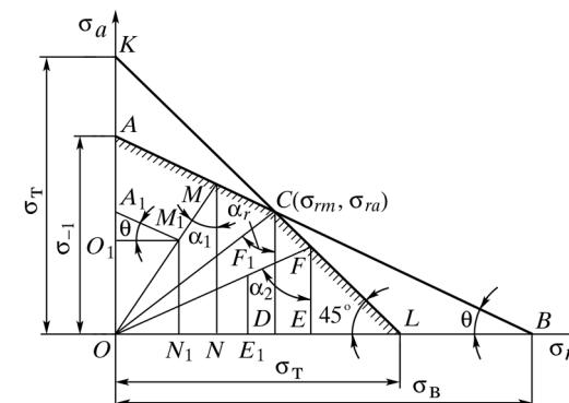
Рис. 55. К выводу формулы для определения коэффициента запаса по усталостному разрушению по схематизированным диаграммам предельных напряжений
