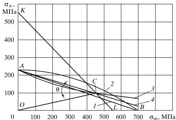
**Рис. 35.** Диаграмма предельных амплитуд  $\sigma_{ra} = f(\sigma_{rm})$  для высокопрочного чугуна ВЧ 50-1,5:
