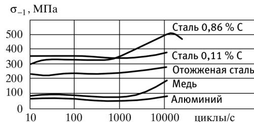
**Рис. 48.** Зависимость предела выносливости от частоты изменения напряжений
