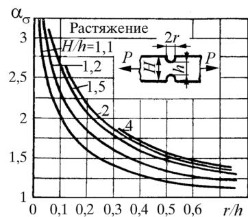
Рис. П7.2. Значение теоретического коэффициента концентрации напряжений от отношения  $r/h$  при известном  $H/h \sigma_h = P/(b \cdot h)$ ;  $\sigma_{\max} = \alpha_{\sigma} \sigma_h$ , где  $b$  — толщина пластиинки
