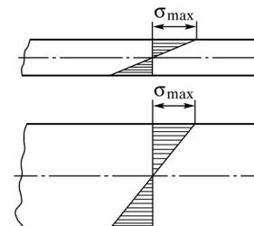
Рис. 41. Градиент напряжений для образцов малого и большого диаметров
