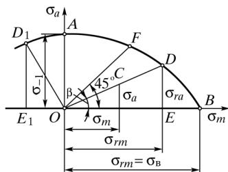
Рис. 23. Диаграмма предельных напряжений в координатах  $\sigma_m$ — $\sigma_a$
