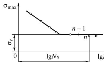
Рис. 10. Кривая выносливости в полулогарифмических координатах для черных металлов
