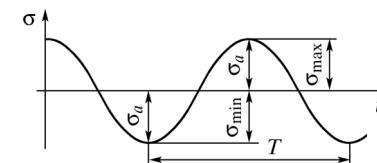
Рис. 2. Симметричный цикл изменения напряжений
