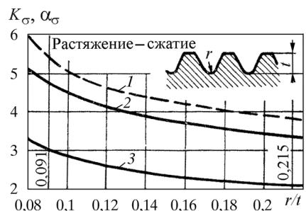
**Рис. П9.1.** 1 —  $\alpha_\sigma$ ; 2 — легированная сталь,  $d = 12$  мм; 3 — углеродистая сталь ( $\sigma_B = 400$  МПа),  $d = 12$  мм; отношение  $r/t = 0,091$  соответствует метрической резьбе, а  $r/t = 0,215$  — резьбе Витворта
