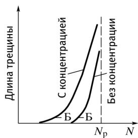
Рис. 13. Характер прогрессивного роста трещины усталости
