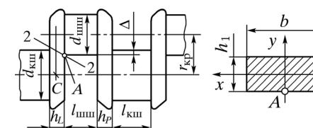
Рис. 67. Расчетная схема щеки коленчатого вала
