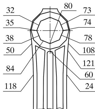
Рис. 78. Конечно-элементная модель поршневой головки
