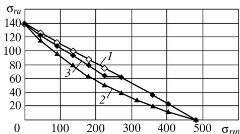
**Рис. 37.** Диаграмма предельных амплитуд для чугуна СЧ 28:
