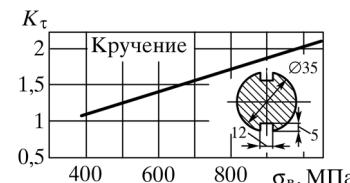
Рис. П12.1. Зависимость коэффициента концентрации напряжений  $K_{\tau}$  от предела прочности  $\sigma_B$  для валов с двумя шпоночными пазами (при одном пазе необходимо вычислить соответствующее значение момента сопротивления  $W_{\text{нетто}}$ )
