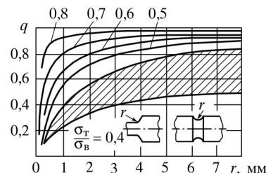
Рис. 40. Графики коэффициента чувствительности  $q$  для стали
