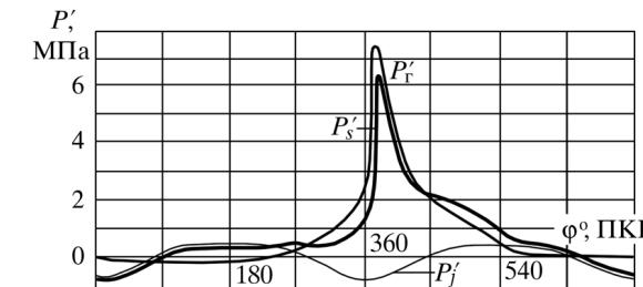
Рис. 60. Графики удельных сил поршневого двигателя  $p'_g$ ,  $p'_j$  и  $p'_s$  по углу поворота коленчатого вала на режиме максимального крутящего момента
