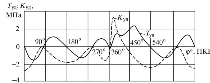
Рис. 61. Графики сил  $K_{уд}$  и  $T_{уд}$  ( $K$  и  $T$ , деленные на площадь поршня  $F_p$ ) в зависимости от угла поворота коленчатого вала
