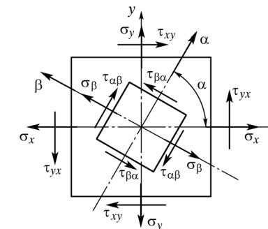
Рис. 75. Напряжения на площадке, расположенной под углом  $\alpha$  к исходной
