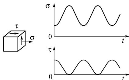
**Рис. 58.** Несинфазное изменение нормальных и касательных напряжений по несимметричным циклам
