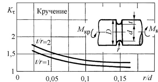
Рис. П6.3. Зависимость  $K_t$  от отношения  $r/d$  и  $t/r$ :
