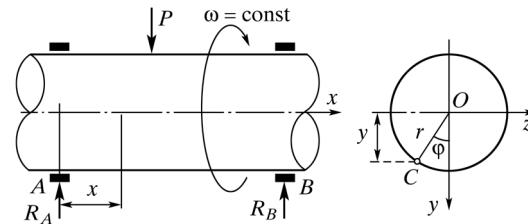
Рис. 1. Вал, нагруженный по симметричному циклу
