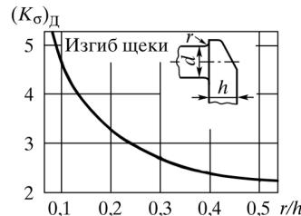
Рис. П13.1. Значение  $(K_\sigma)_D = K_\sigma / \epsilon_\sigma$  при изгибе щеки коленчатого вала при  $d = 40 \dots 70$  мм
