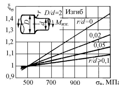
**Рис. П2.2.** Поправка  $\xi_\sigma = \frac{(K_\sigma)_{\sigma_B}}{(K_\sigma)_{\sigma_B=500}}$ , учитывающая влияние предела прочности  $\sigma_B$
