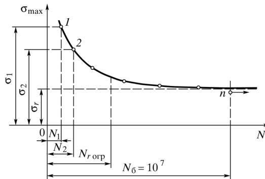
Рис. 8. Кривая выносливости (кривая Велера) в координатах  $N$ — $\sigma_{max}$  для черных металлов
