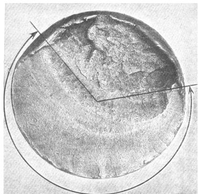
Рис. 15. Характерный внешний вид усталостного излома металла
