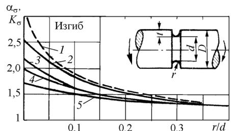
**Рис. П5.1.** Коэффициенты концентрации напряжений при изгибе вала с кольцевой выточкой ( $t/r = 1$ ):
