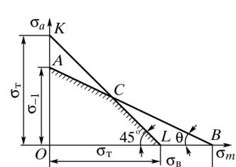
Рис. 30. Схематизированная диаграмма предельных напряжений Гудмана
