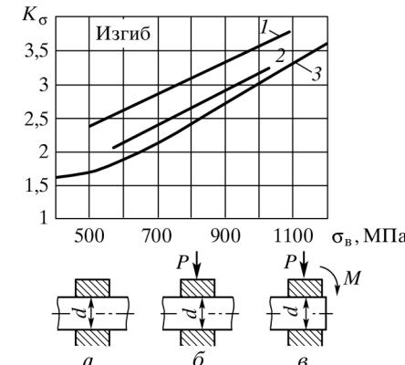
Рис. П8.1. Значение эффективного коэффициента концентрации напряжений для вала с напрессованной деталью:
