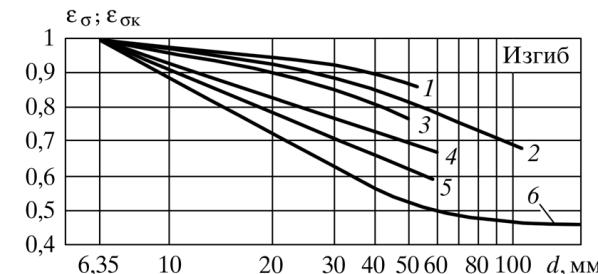
**Рис. 42.** Значения коэффициентов влияния абсолютных размеров при изгибе:
