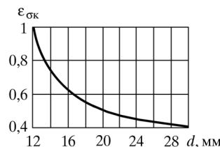
Рис. П11.1. Зависимость масштабного коэффициента с концентрацией напряжений от диаметра резьбы
