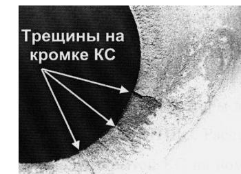
Рис. 19. Развитие трещин в кромке камеры сгорания тракторного дизеля
