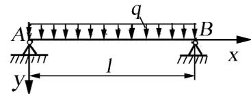
Рис. 1. Балка со свободно опертыми краями и нагруженная равномерно распределенной нагрузкой
