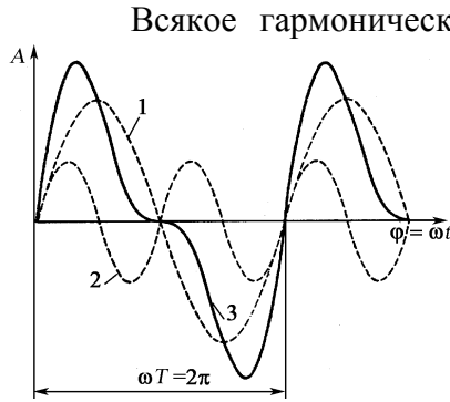
Рис. 23. Сложение двух гармонических движений различных частот: 1 – a \sin \omega t ; 2 – (a/2) \sin 2\omega t ; 3 – суммарное (негармоническое)
