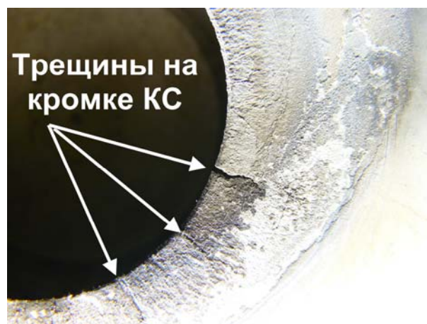
Рис. 4.1. Расположение трещин в кромке КС поршня тракторного дизеля
