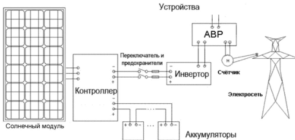
Рис. 14. Солнечная электростанция (с аккумуляторами) с использованием электрической сети как резервного источника питания.
