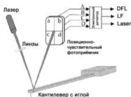
Рис. 6.2. Оптическая схема регистрации отклонения кантилевера
