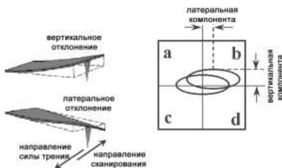
Рис. 6.3. Смещение лазерного пятна при отклонении кантилевера
