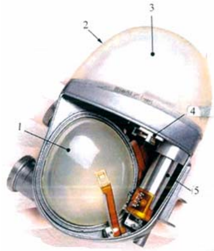
Рис. 1.22. Устройство КИЖ СПИ ОЛЖ HeartSaver VAD: 1 – НУК; 2 – КК; 3 – АСУ; 4 – гидравлический клапан; 5 – конвертер
