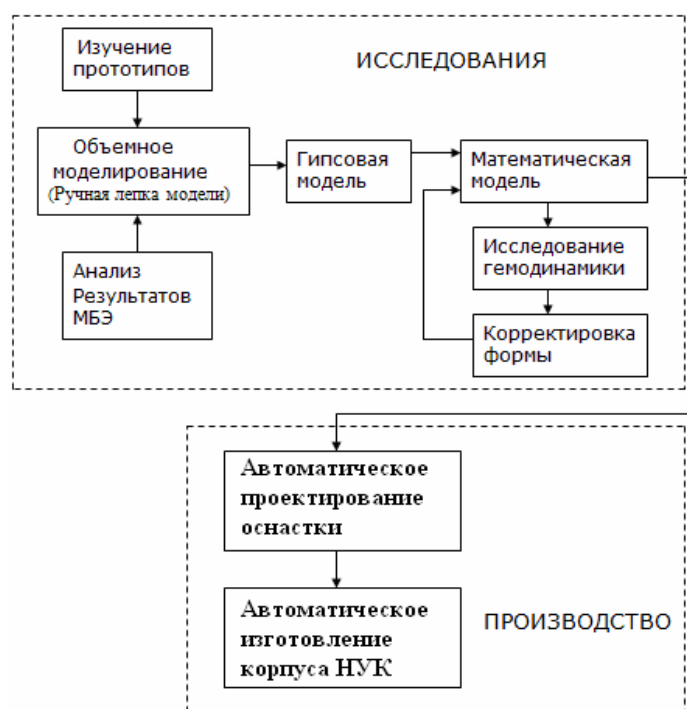
Схема комплексного процесса биотехнического проектирования НУК по сквозной технологии на базе САД-систем
