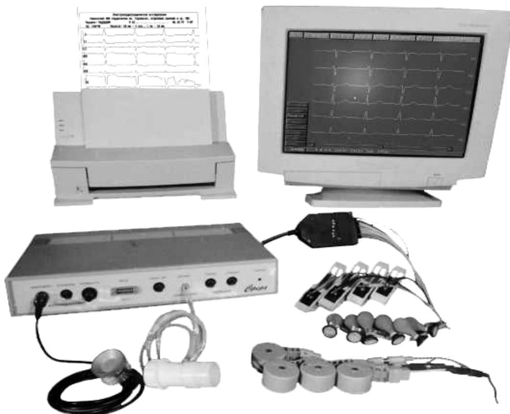
Внешний вид и полная комплектация регистрационно-измерительного канала фонокардиографии
