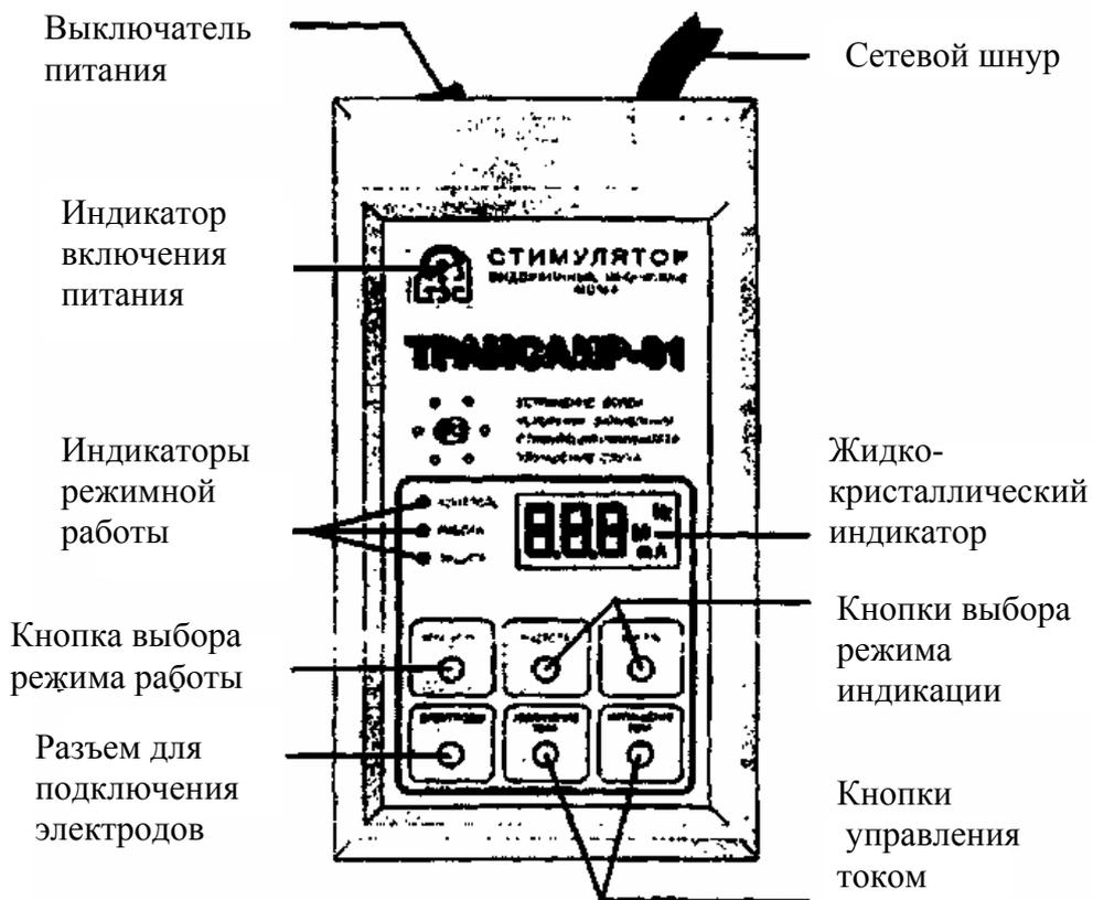
Рис. 11. Транскраниальный импульсный биполярный стимулятор «ТРАНСАИР-01»
