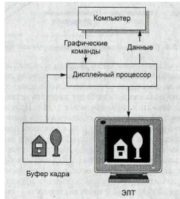
Рис. 3.5. Компоненты растрового графического устройства
