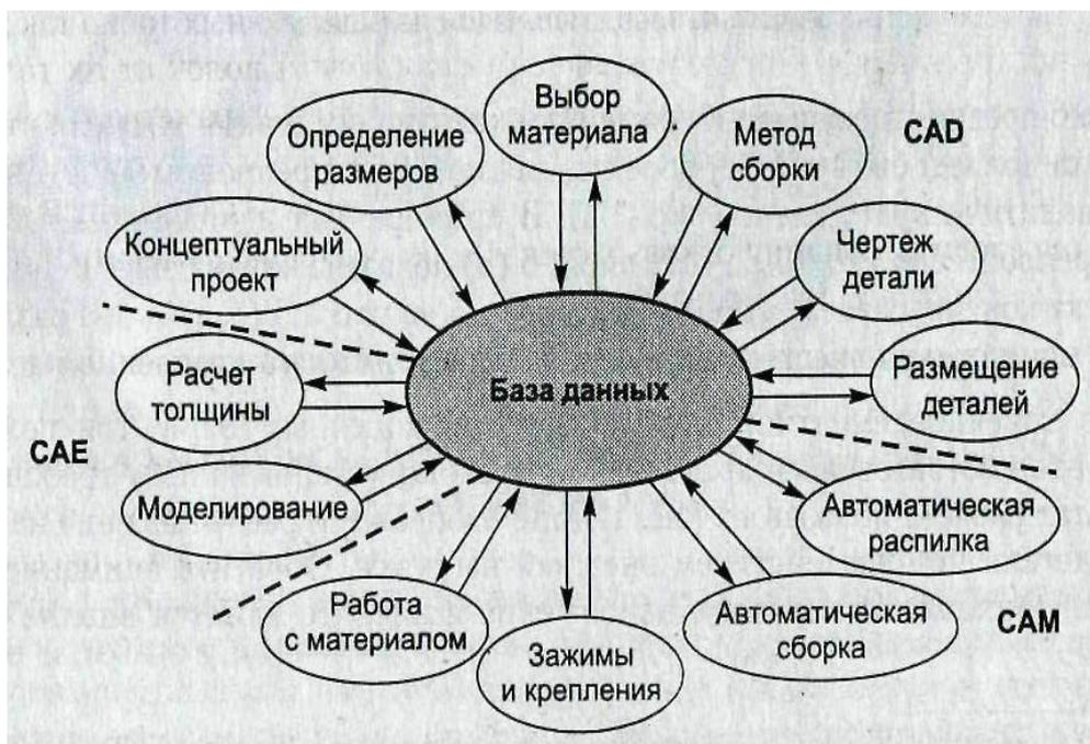
Рис. 2.3. Интеграция CAD, CAM и CAE через базу данных
