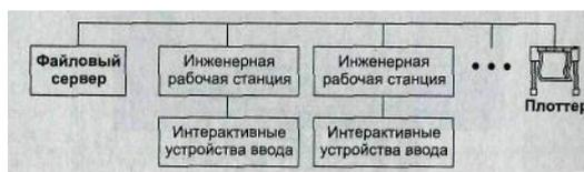
Рис. 3.12. Рабочие станции объединенные в сеть
