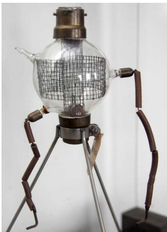
Рис. 1.6. Первая в мире радиолампа с водяным охлаждением
