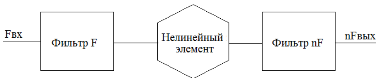
Рис. 5.23. Структурная схема умножителя
