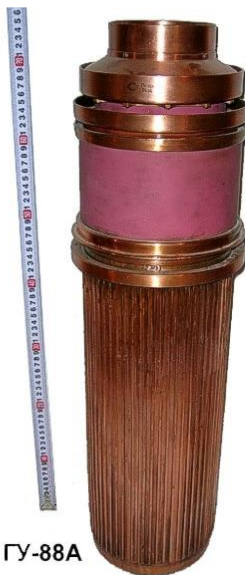
Рис. 1.7. Радиолампа мощностью 500 кВт
