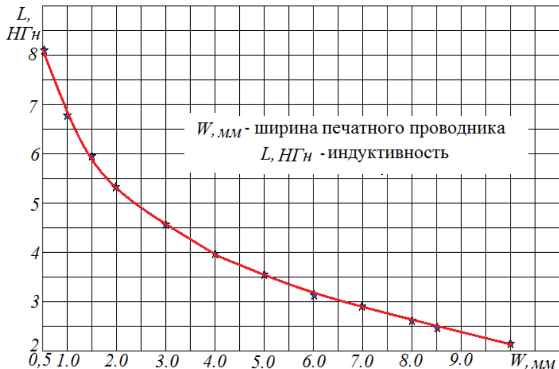
Рис. 6.8. Погонная индуктивность L на 1 см длины при разных W
