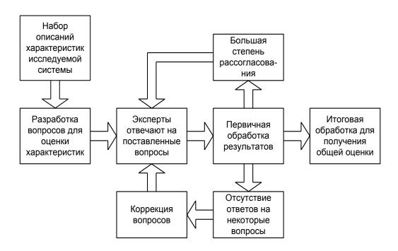
Рис. 3.5. Алгоритм получения экспертных оценок качественных параметров
