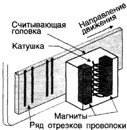
Рис. 36. Конструкция считывателя
