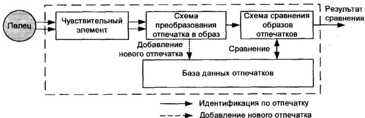
Рис. 48. Структурная схема считывателя отпечатка пальцев
