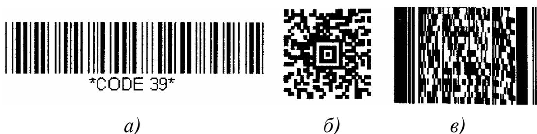
Рис. 29. Примеры штрих-кодов: а – одномерного; б, в – двумерных
