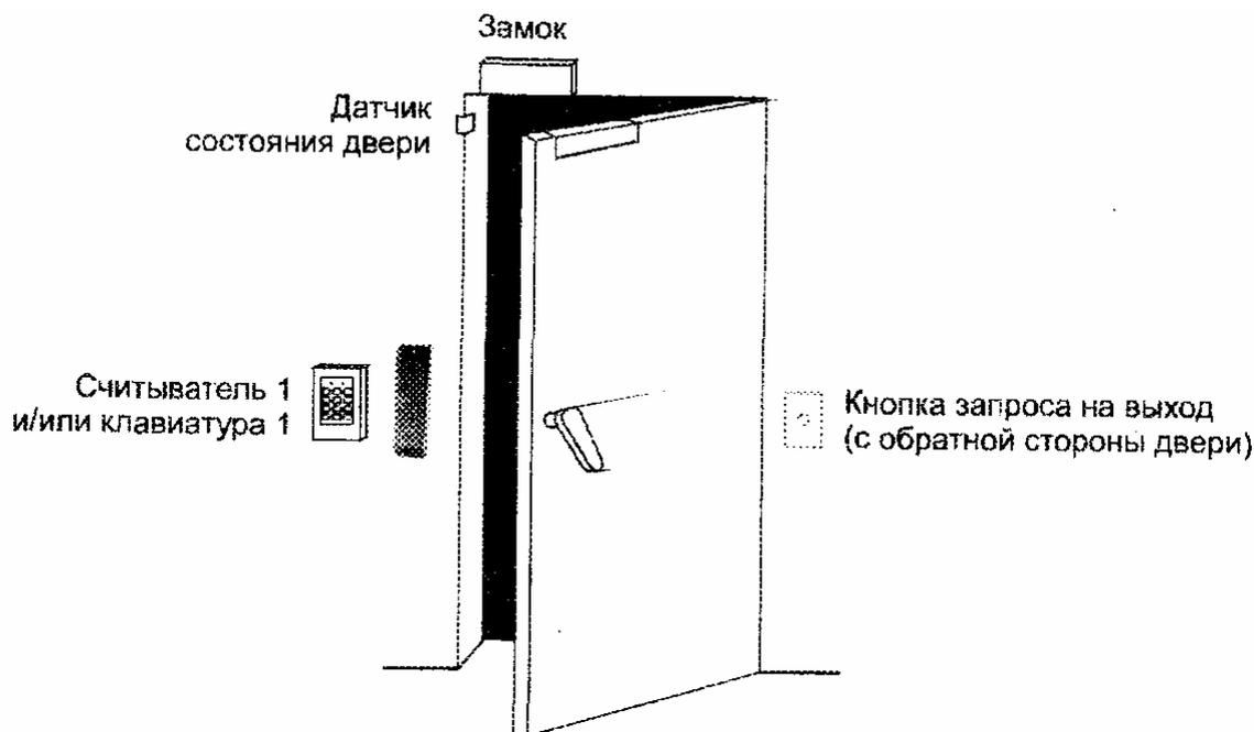
Рис. 12. Технические средства точки доступа с односторонним контролем
