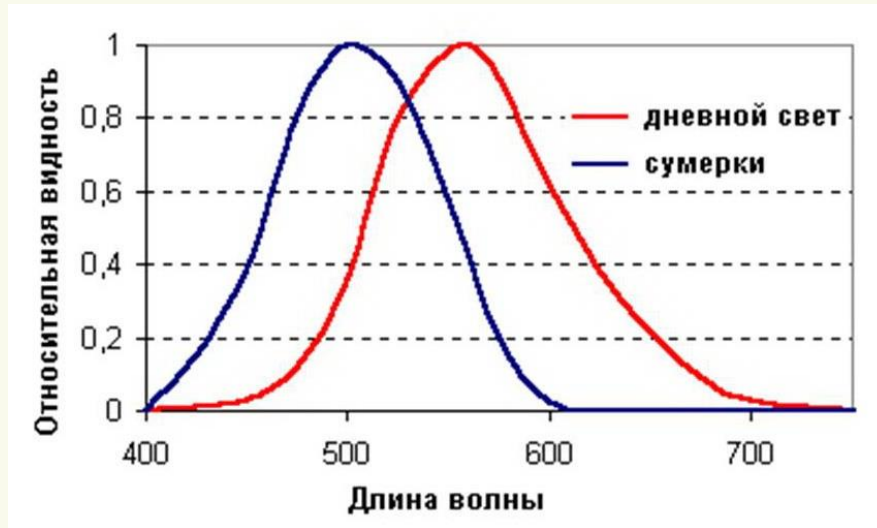
Рис. 2.13. Кривые спектральной чувствительности глаза при различных условиях внешнего освещения в сумерках и при дневном освещении
