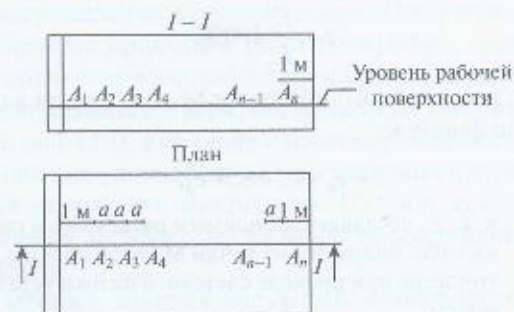
Рис. 2.2. Характерный поперечный разрез помещения для измерения к. е. о. при боковом освещении
