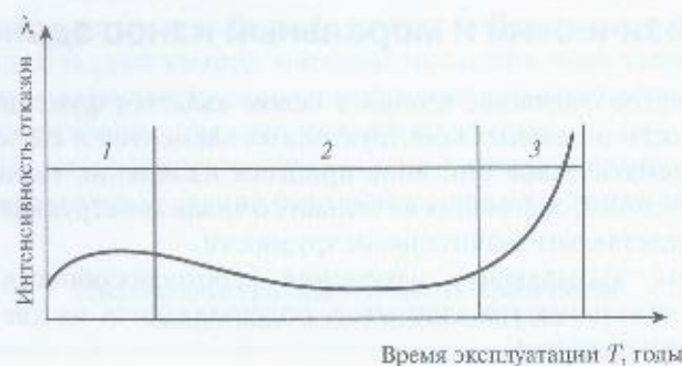
Рис. 1.1. Интенсивность отказов элементов как функция времени эксплуатации: 1 — период приработки; 2 — период нормальной эксплуатации (внезапные отказы); 3 — период интенсивного износа (внезапные и износосвые отказы)
