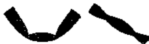
Рис. 7.11. Нелинейные деформации в напряженной однослойной (10,10) нанотрубке. Слева — изогнутая нанотрубка, справа — скрученная нанотрубка. Воспроизводится с разрешения из [7.13]. Copyright 1999 American Chemical Society
