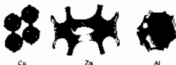
Рис. 6.11. Поверхности Ферми в некоторых металлах: Cu и Al (ГЦК-решетка), Zn (гексагональная ячейка). Воспроизводится с разрешения из [6.8]. Copyright 1960 American Physical Society
