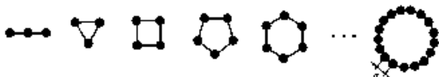
Рис. 6.4. Образование периодической системы на примере одномерной атомной цепочки
