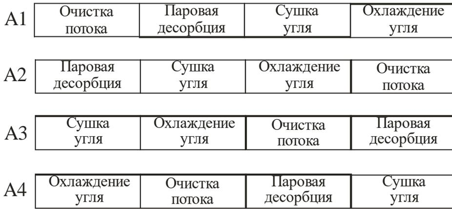
Рис.2.13. Циклограмма четырехстадийного процесса с паровой регенерацией адсорбента
