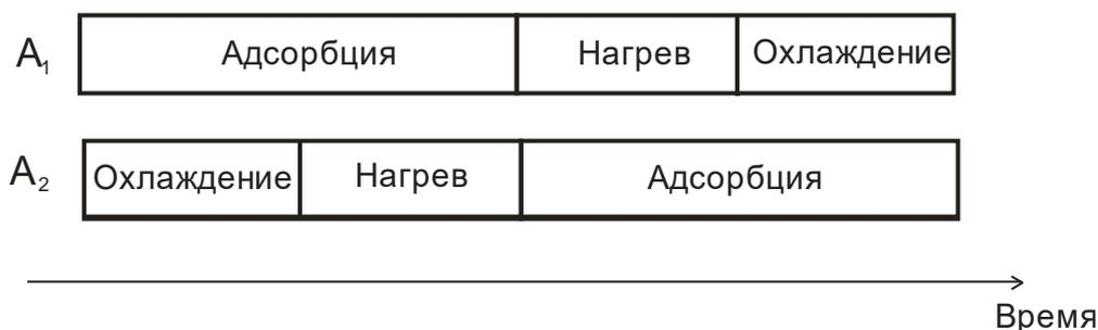
Рис.2.6. Циклограмма работы двухадсорберной установки, схема которой приведена на рис.2.5: А – адсорбция, Н – нагрев, О – охлаждение.
