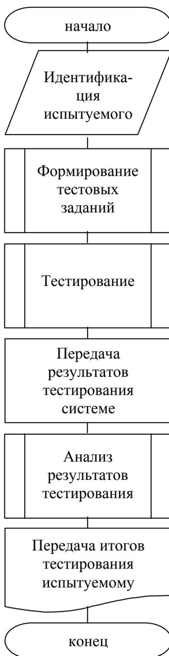
Рис. 9. Блок-схема алгоритма функционирования системы тестирования
