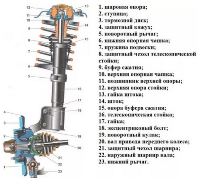
Рисунок 1 – Передняя подвеска ВАЗ-2108
