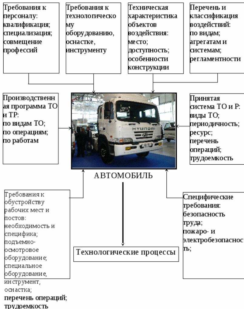
Рис. 10.3 – Факторы, влияющие на проектирование технологических процессов ТО и ремонта
