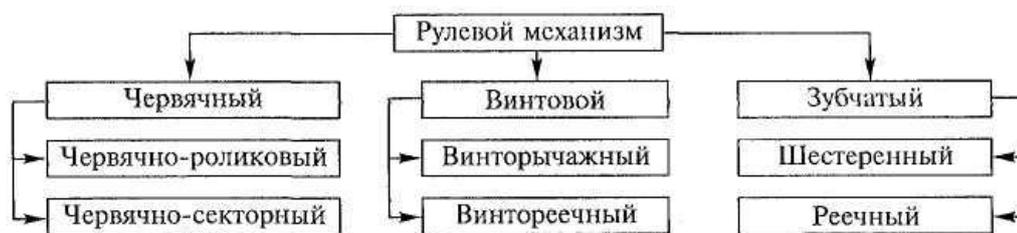
Рис. 4. Типы рулевых механизмов
