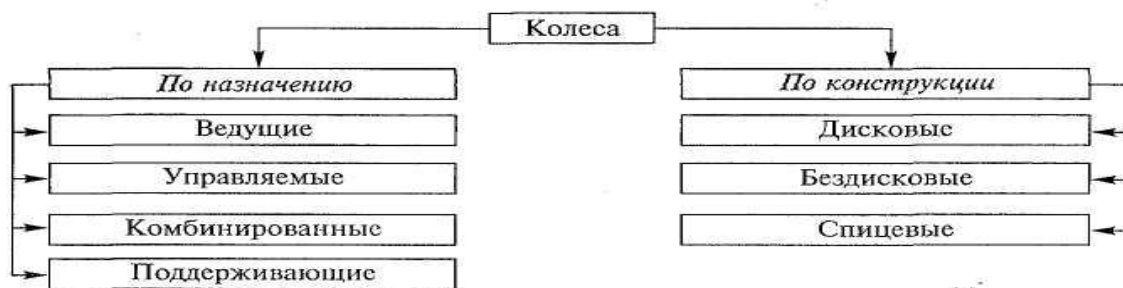
Рис. Типы колес, классифицированные по различным признакам
