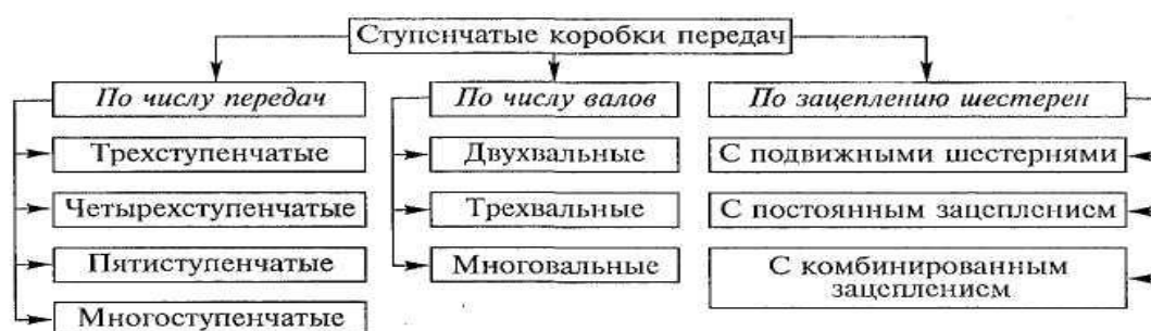
Рис. Типы ступенчатых коробок передач, классифицированные по различным признакам
