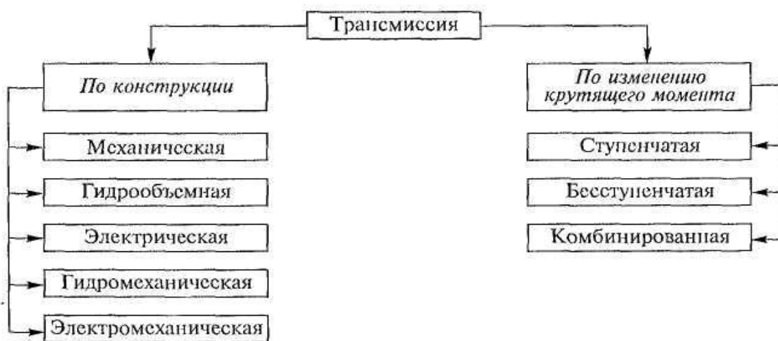
Рис. Типы трансмиссий автомобилей, классифицированные по различным признакам
