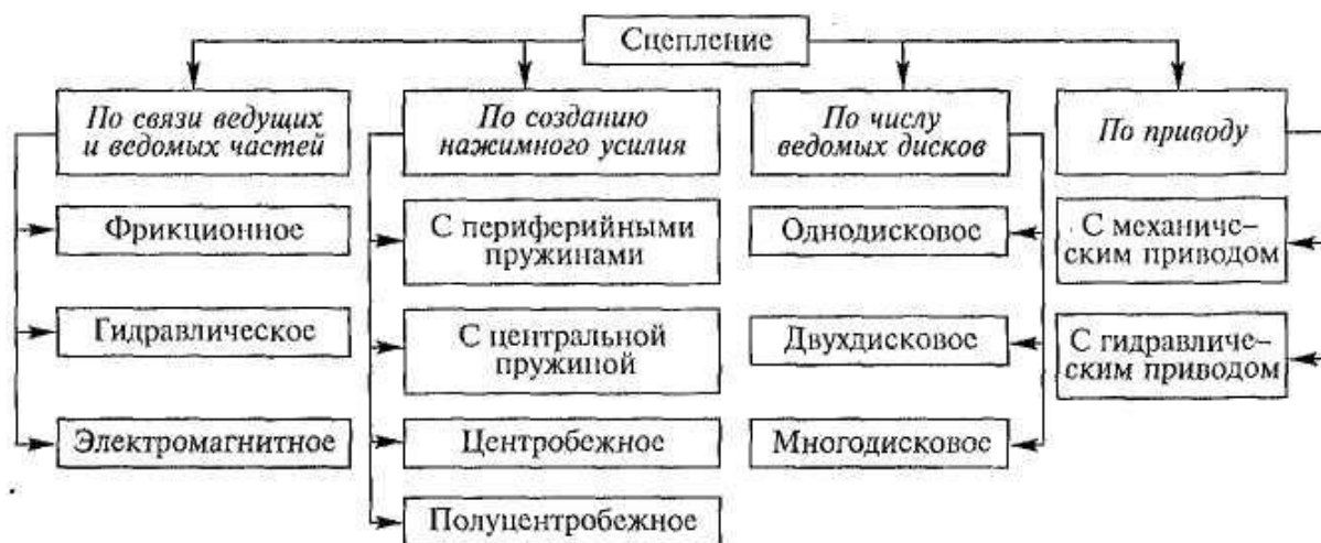
Рис. Типы сцеплений, классифицированные по различным признакам
