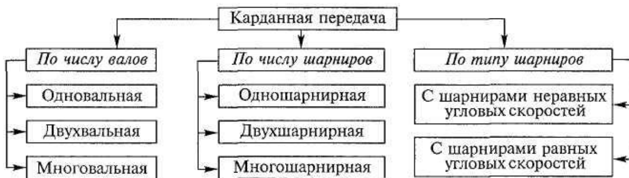
Рис. Типы карданных передач, классифицированные по различным признакам
