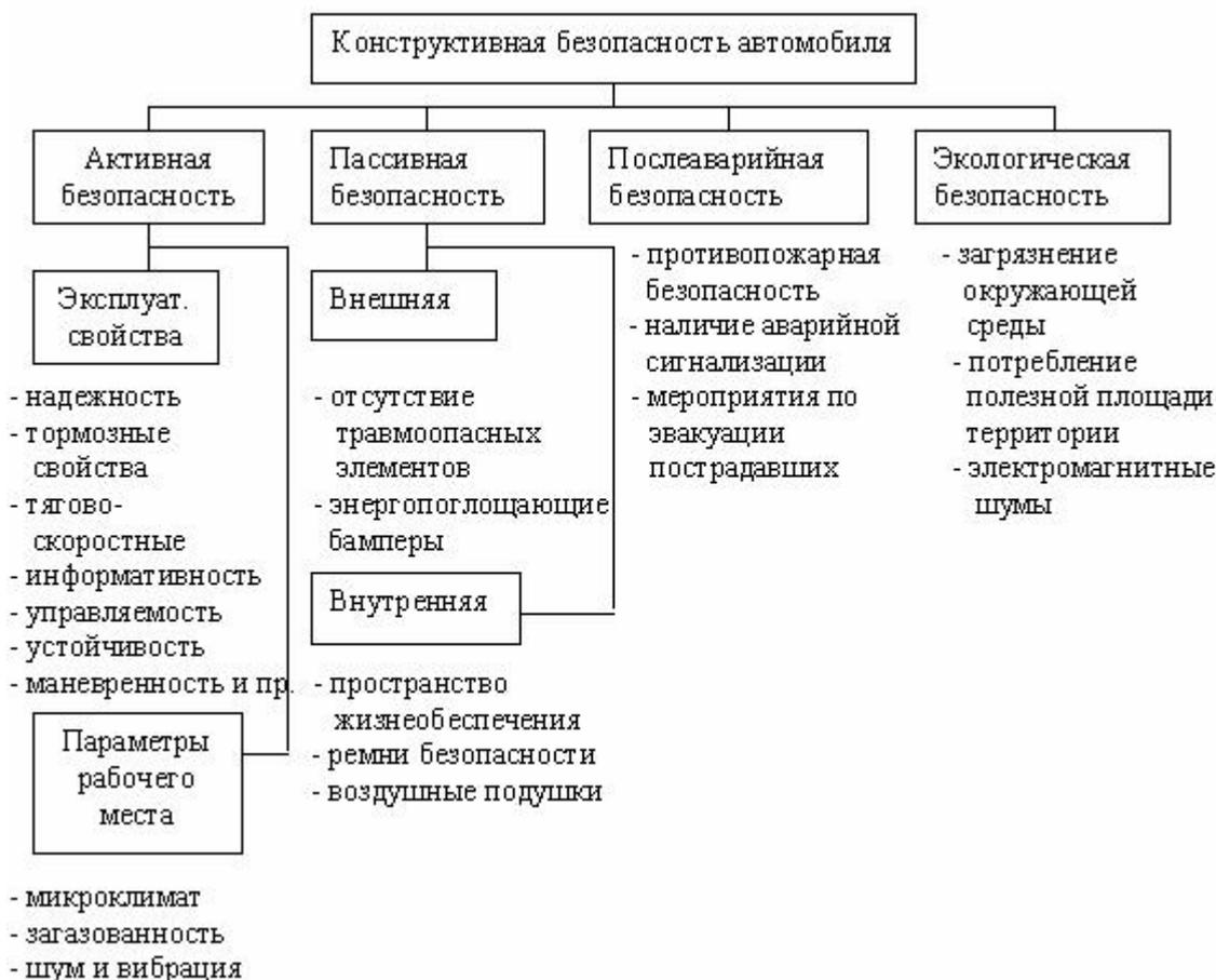
*Рис. 10. Конструктивная безопасность автомобиля*
