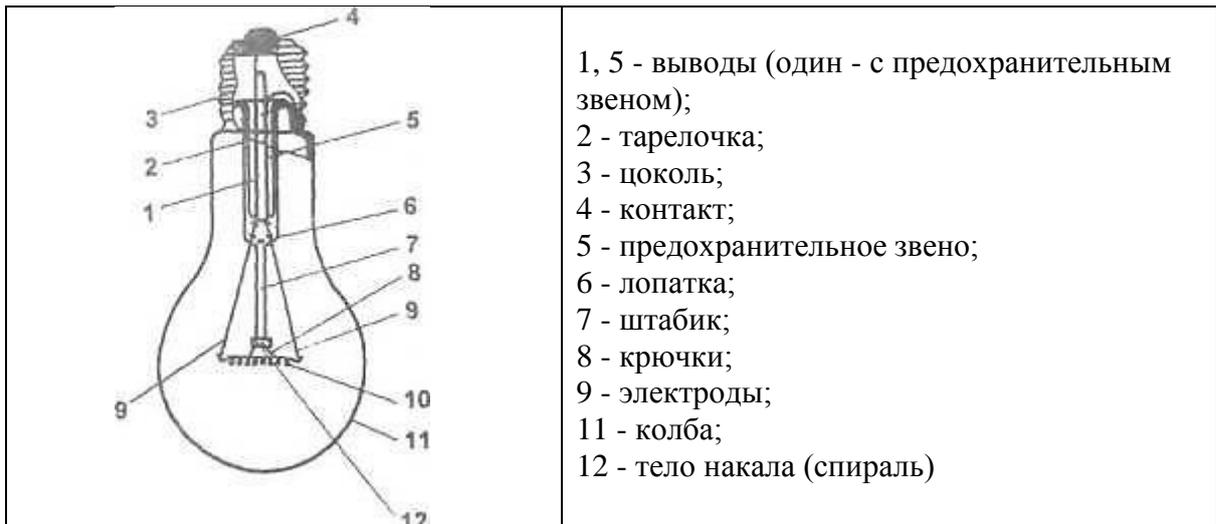
**Рис. П. 2.4. Лампа накаливания**
