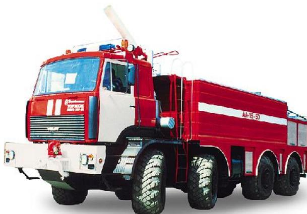
Рис.70. Пожарный аэродромный автомобиль АА-15/80-100/3 (790912) ПМ-539
