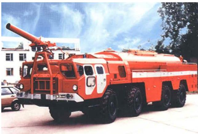
Рис.71. Пожарный аэродромный автомобиль АА-60(7310)160.01
