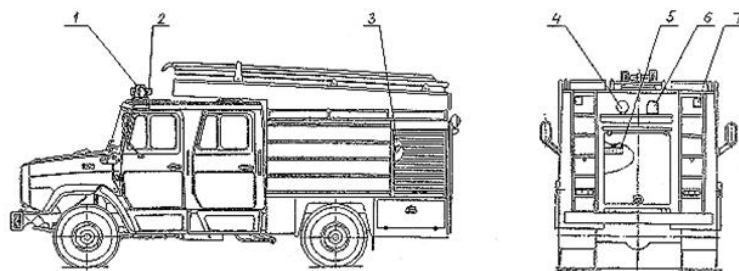
Рис. 59 Размещение дополнительного электрооборудования на пожарной автоцистерне АЦ-2,5-40(433362)ПМ-540
