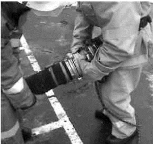
Для присоединения всасывающей сетки водитель приподнимает ближний к водоему конец рукава, пожарный, опустившись на колено, присоединяет к нему сетку и затягивает соединение ключами.
