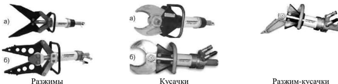
Ножницы гидравлические НГ 25 (НГ 63) предназначены в основном для резки листового материала.
