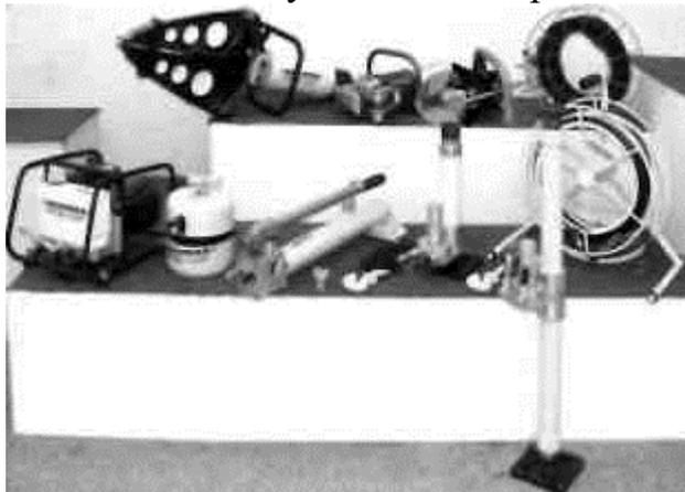
Комплекты АСИ разработаны на 3 уровня рабочих давлений в гидросистеме: 25, 32 и 63 МПа. Соответственно в применяемых комплектах должны быть согласованы источники рабочей жидкости (насосы и насосные станции) и исполнительные устройства (инструменты).
