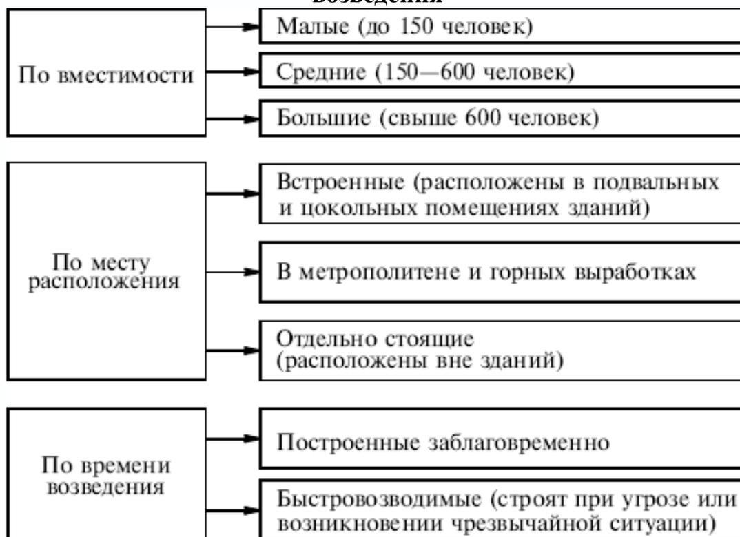
Убежища обеспечивают защиту укрывающихся в них людей от всех поражающих факторов ядерного взрыва, ударной волны, отравляющих веществ, бактериологических средств и теплового воздействия при пожарах. Их возводят на участках местности, не подвергающихся затоплению. Они имеют входы и
