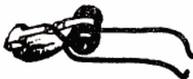
**Рис. 41. Положение боевой пружины на курке**
