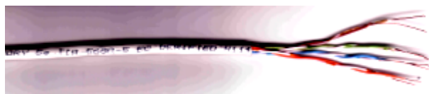
Рис. 2.14. Неэкранированная витая пара
