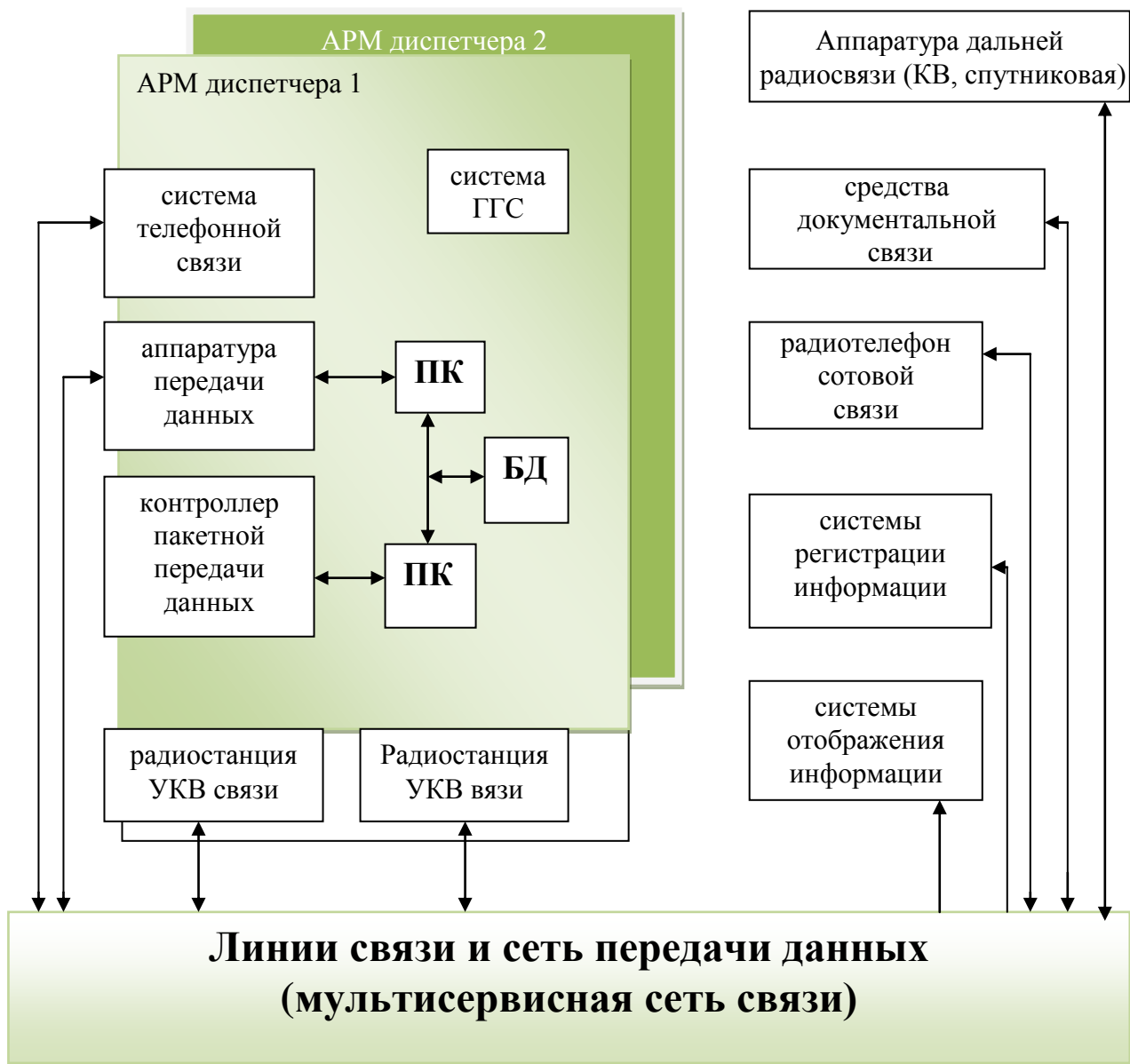
Рис. 6.2. Комплекс технических средств центрального диспетчерского пункта связи
