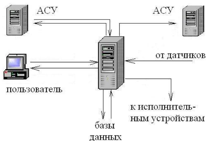
Рис. 5.1. Функциональная схема АСУ
