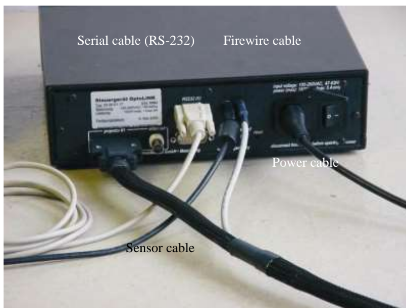
Рис.2. Подключение блока управления
