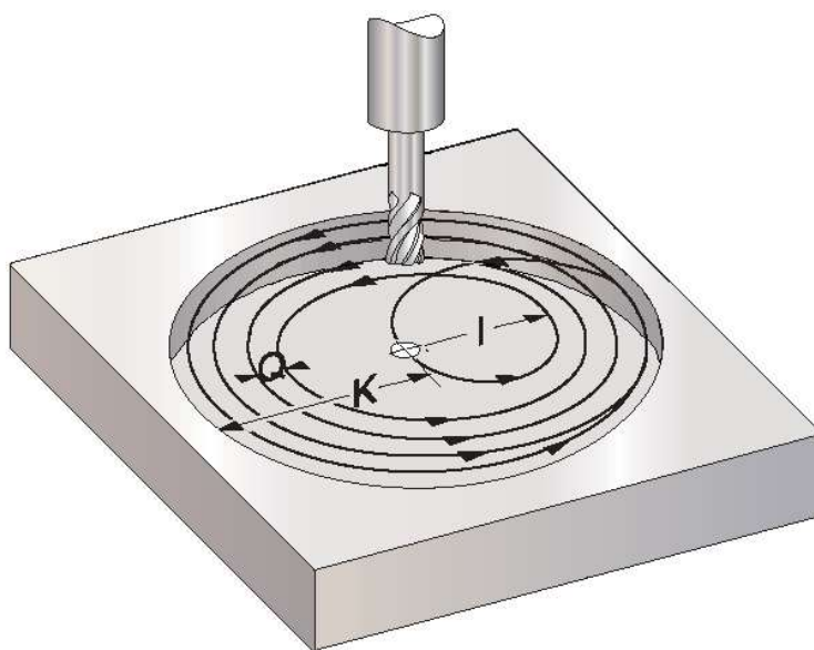
Рис. 14. Схема фрезерования кругового кармана
